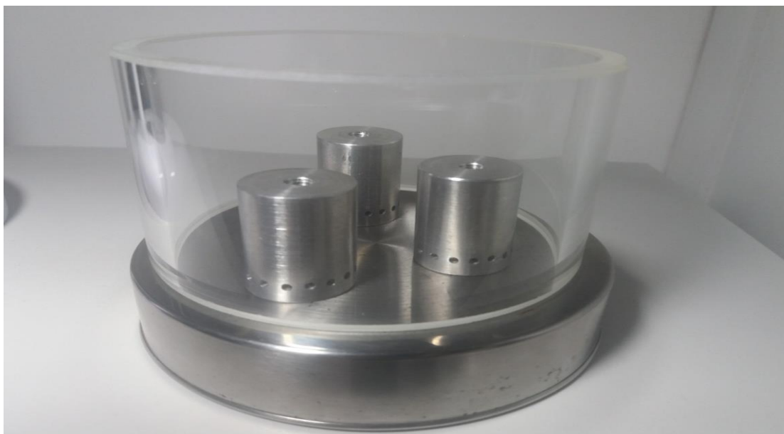
Figura 27 – Foto do gomo em vidro borossilicato e borbulhador em alumínio.
