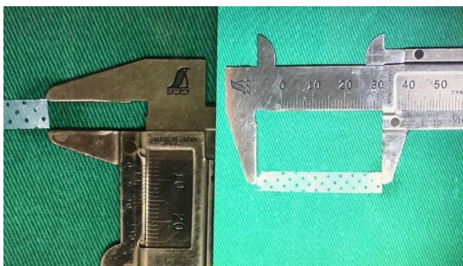
Figura 4. Dimensões da membrana de biopolímero de cana-de-açúcar BPCACEM.
