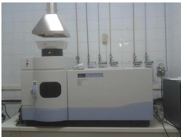
**Figura 4.** Espectrômetro de emissão óptica com plasma acoplado indutivamente (ICP OES) modelo Optima 7000 DV (Perkin Elmer, USA).
