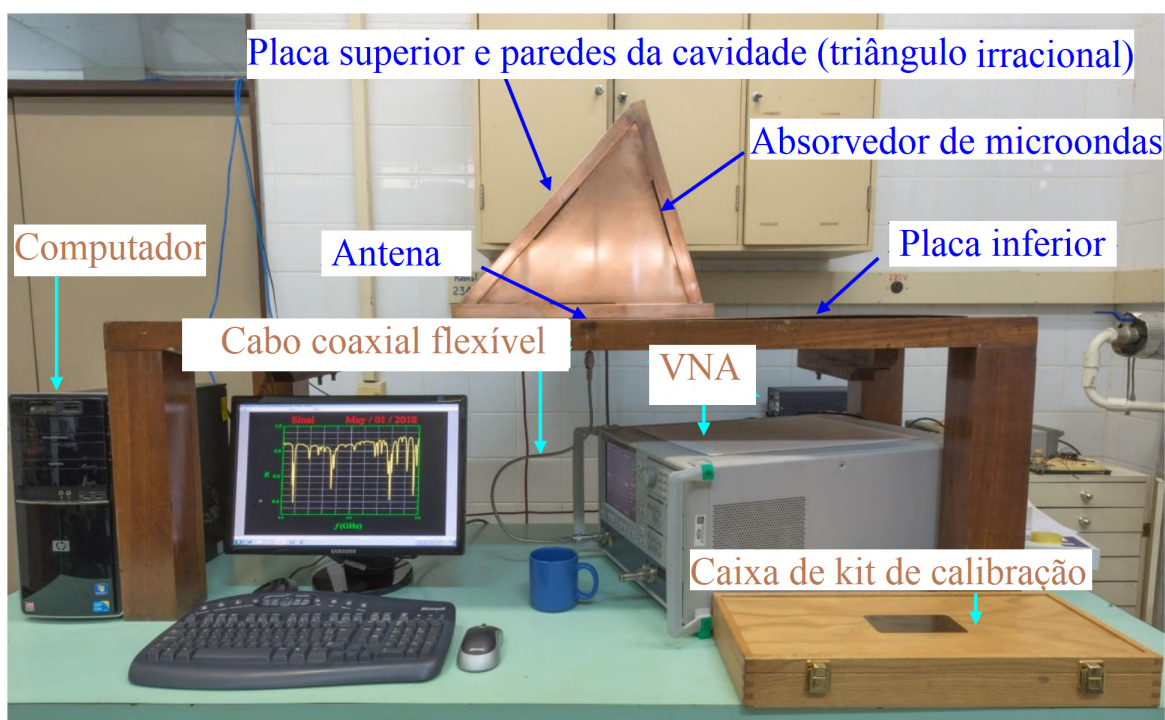
Figura E.1: Fotografia do aparato experimental para as medidas de espalhamento. A placa superior e paredes da cavidade do triângulo irracional são erguidas, expondo as três fitas pretas dos absorvedores de micro-ondas.
