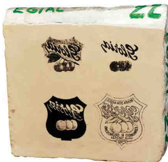
Figura 58 - Exemplo de matriz para cromolitografia e resultado da impressão
