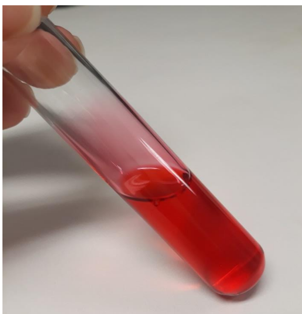
Figura 21 - Teste de corante realizado para a ME1 com 0,2% de VBM.
