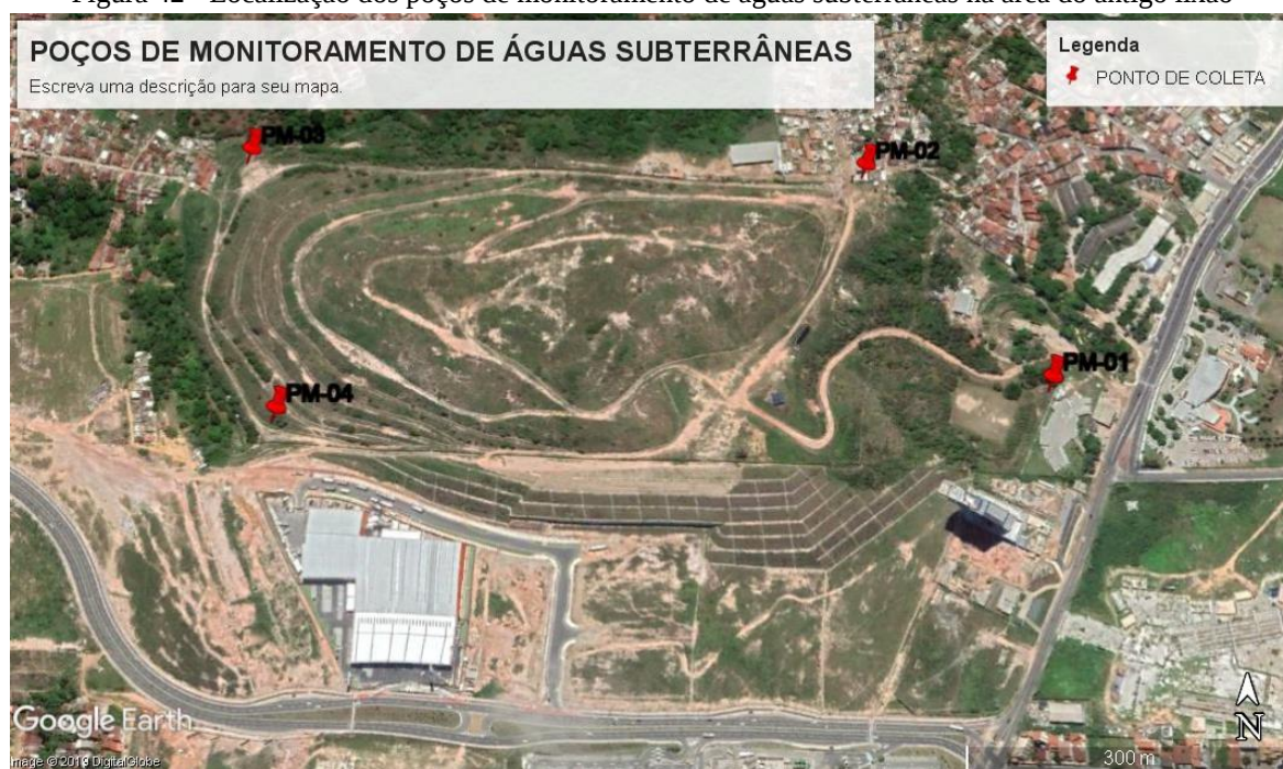
Figura 42 - Localização dos poços de monitoramento de águas subterrâneas na área do antigo lixão
