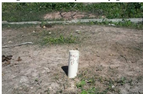
Figura 20 - Marco superficial topográfico
