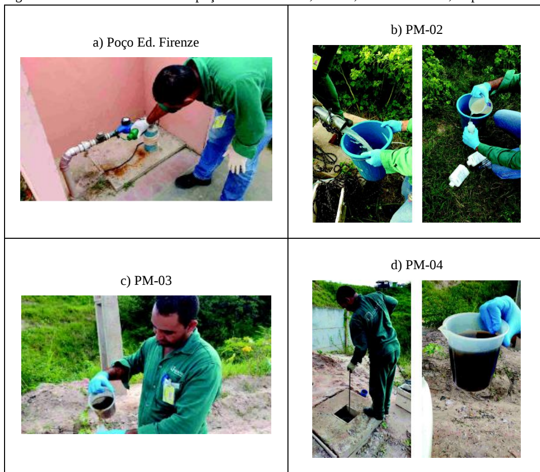
Figura 43 - Coleta de amostras nos poços do Ed. Firenze, PM-02, PM-03 e PM-04, respectivamente.
