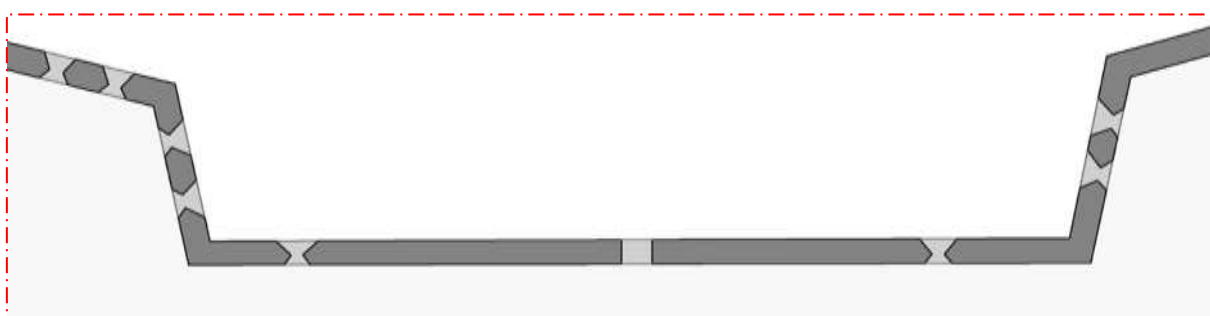
Figura 209 – Cortina sul. Notar abertura da antiga latrina no centro. Fonte: Elaborada pelo autor.
