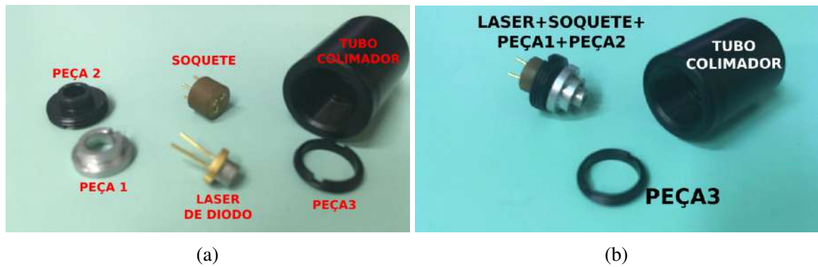
Figura 15 – Peças para a montagem da cabeça do laser Teco.
