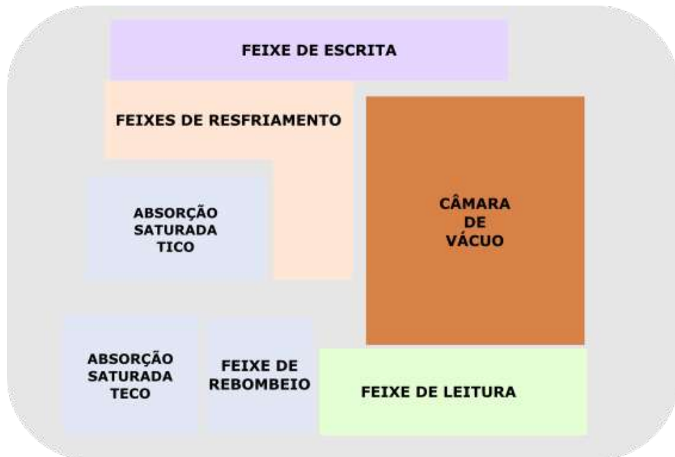
Figura 60 – Esquema da montagem dos vários aparatos que compõem a Armadilha Magneto-Óptica na mesa óptica.
