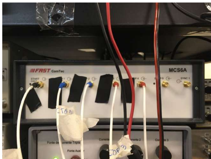
Figura 69 – Placa de fotocontagem FAST ComTec modelo-MCS6A, onde as entradas são: start (pulso do Arduino), canal 1 (fóton 1), canal 2 (fóton 1), canal 3 (fóton 2) e canal 4 (fóton 2).
