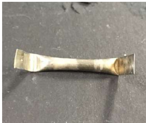
Figura 35 – Dispenser de rubídio utilizado na Armadilha Magneto-Óptica. Ele contém uma liga de metais, na qual se inclui o ^{85}\text{Rb} e o ^{87}\text{Rb} .
