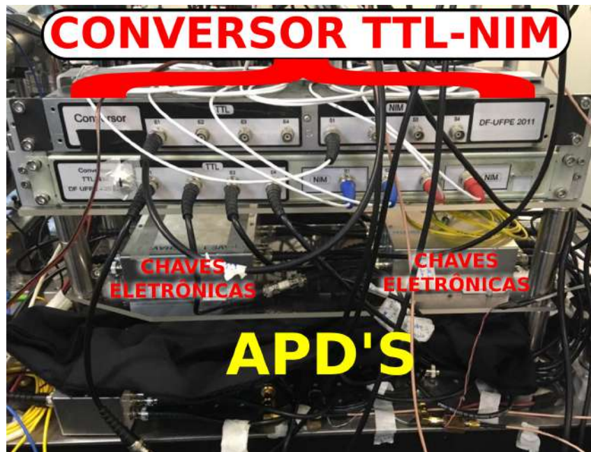
Figura 68 – Montagem do sistema de fotodetecção dos fótons dos campos 1 e 2, seleção e conversão de sinal.
