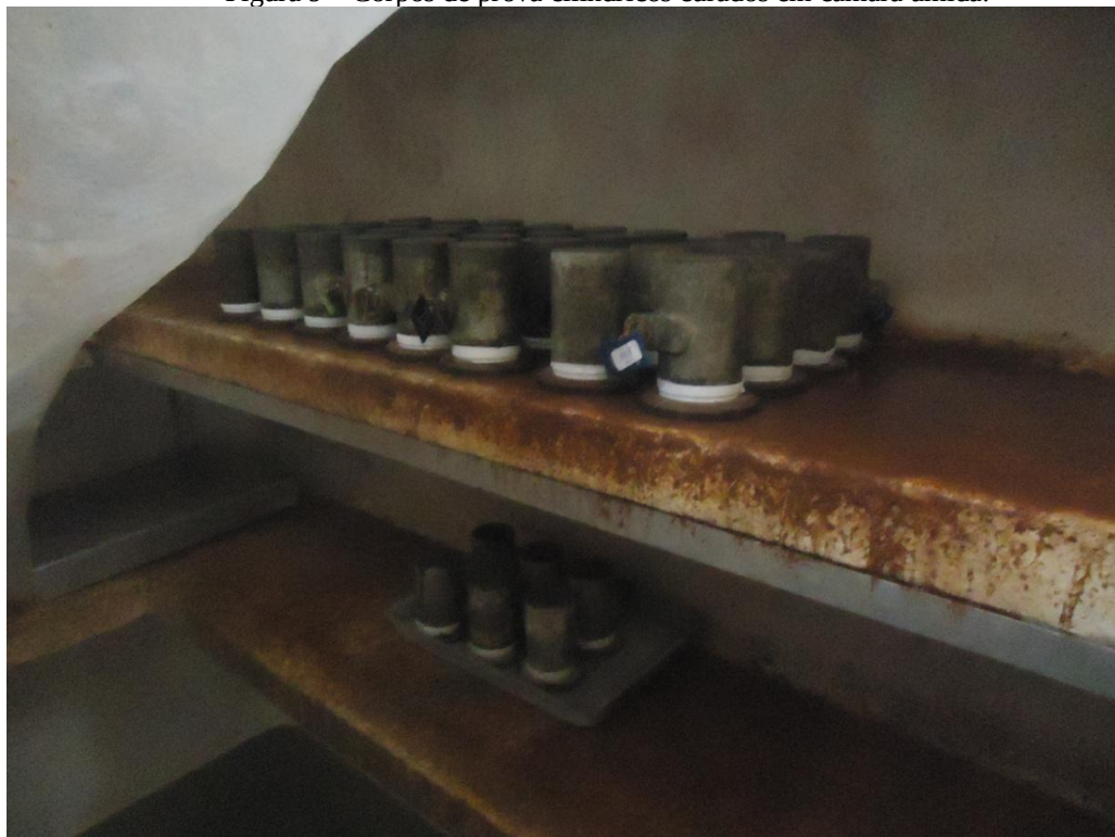
Figura 9 – Corpos de prova cilíndricos curados em câmara úmida.
