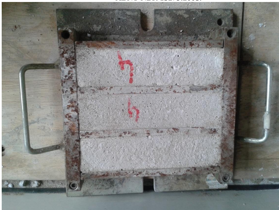
Figura 12 – Moldagem de corpos de prova prismáticos em forma metálica de 4 cm x 4 cm x 16 cm de acordo com a ABNT NBR 13279:2005.
