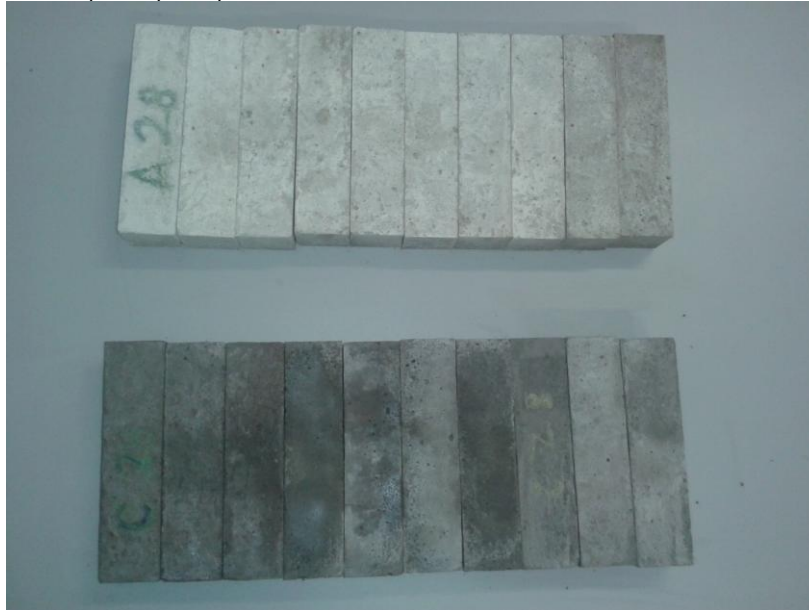
Figura 14 – Corpos de prova prismáticos de 4 cm x 4 cm x 16 cm de acordo com a ABNT NBR 13279:2005.
