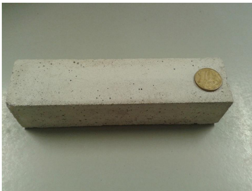
Figura 13 – Corpo de prova prismático de 4 cm x 4 cm x 16 cm de acordo com a ABNT NBR 13279:2005
