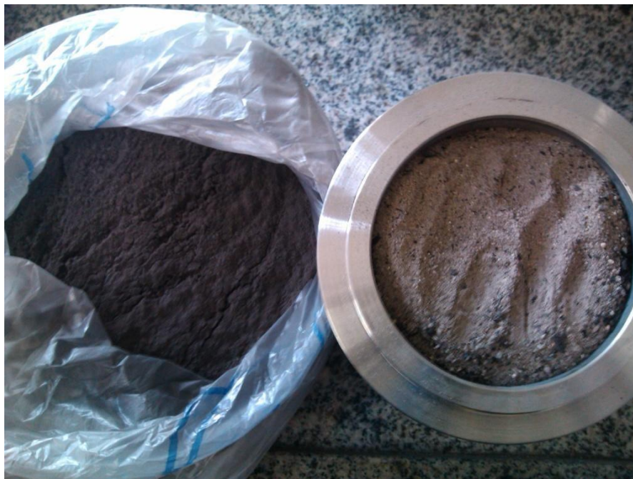
Figura 7 – Aspectos visuais da cinza moída (A2) e da cinza tal qual recebida da indústria (A1)
