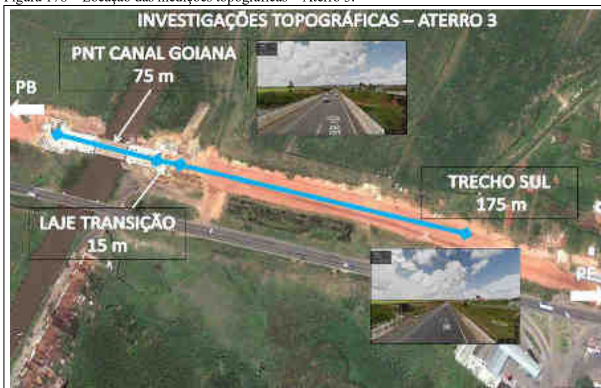
Figura 178 – Locação das medições topográficas – Aterro 3.
