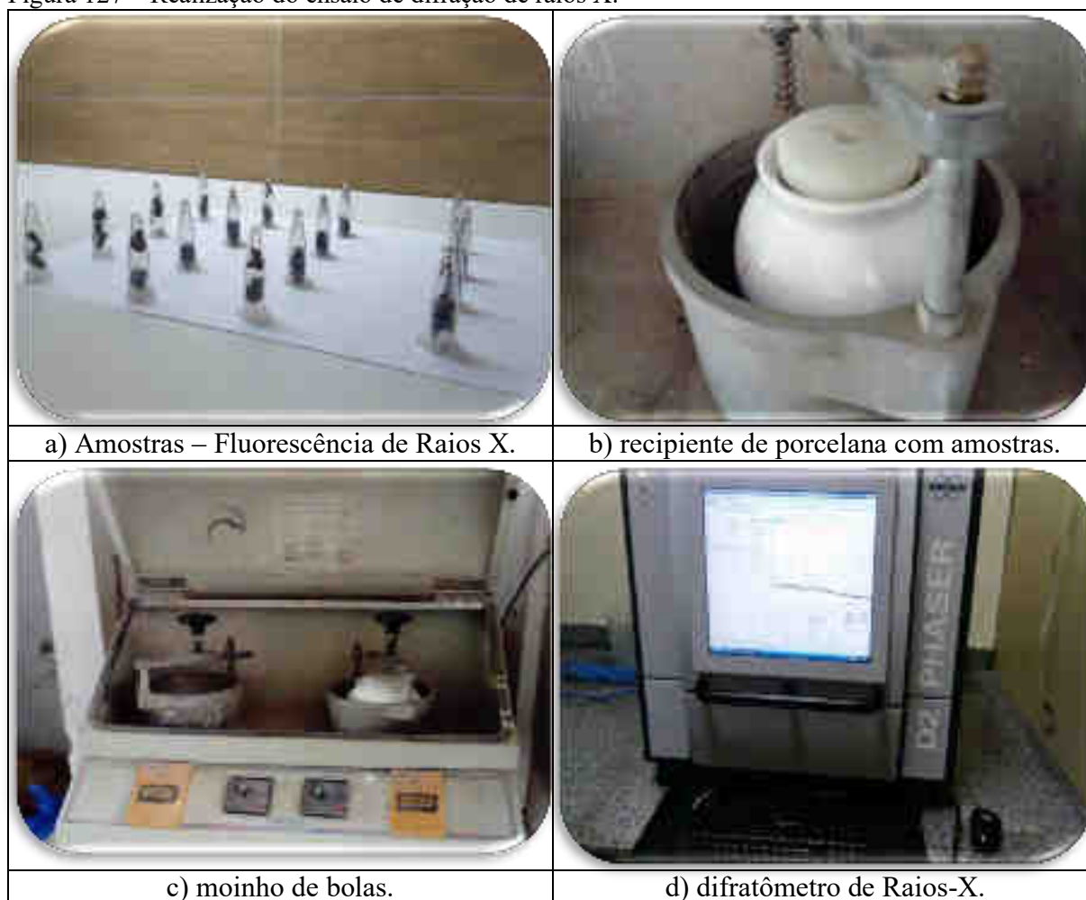
Figura 127 – Realização do ensaio de difração de raios X.
