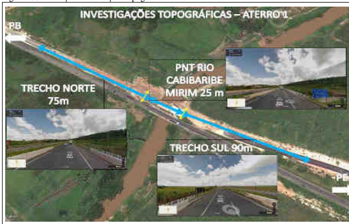
Figura 176 – Locação das medições topográficas – Aterro 1.
