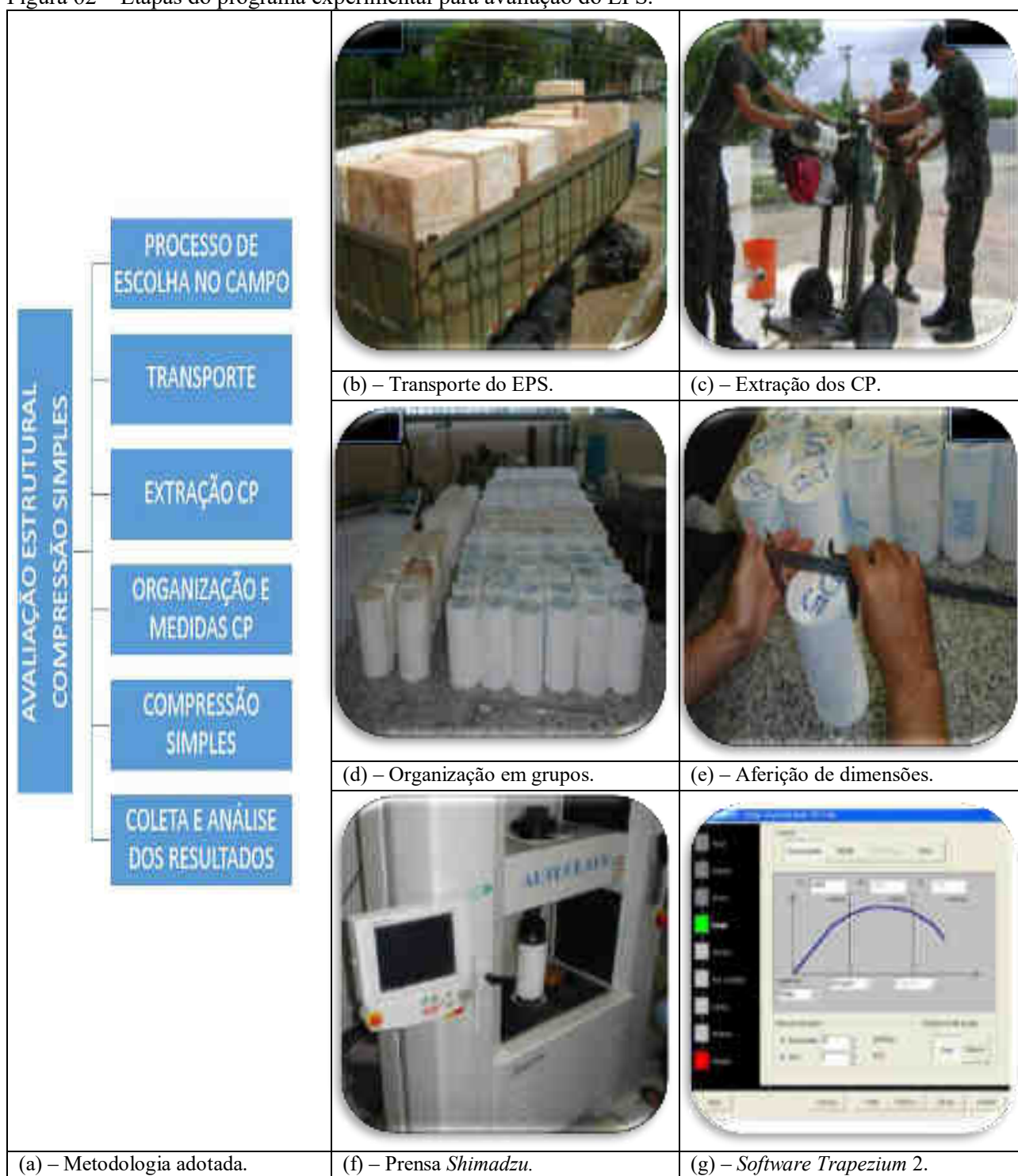
Figura 62 – Etapas do programa experimental para avaliação do EPS.
