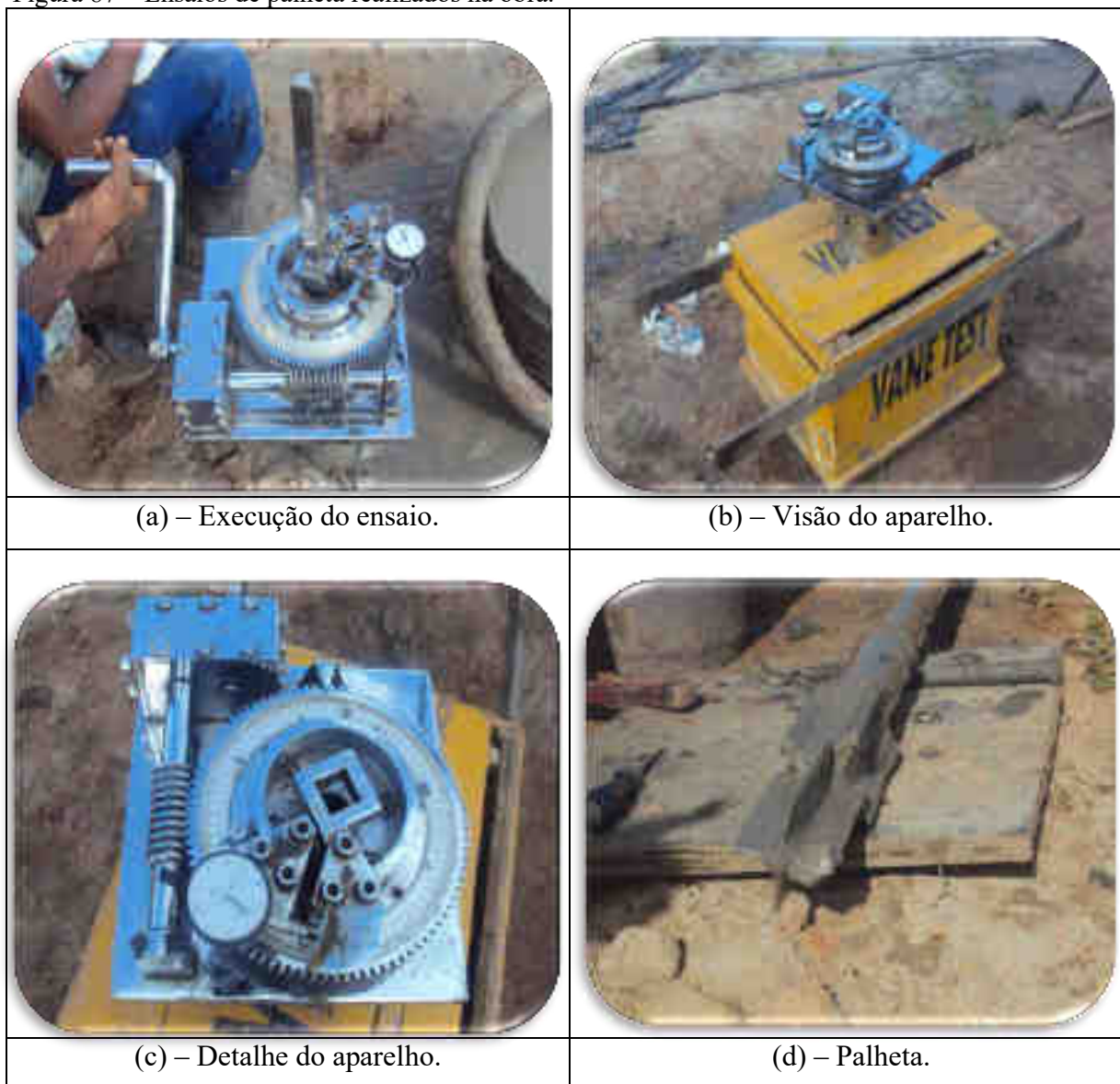
Figura 87 – Ensaios de palheta realizados na obra.
