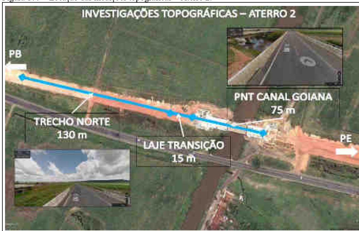
Figura 177 – Locação das medições topográficas – Aterro 2.
