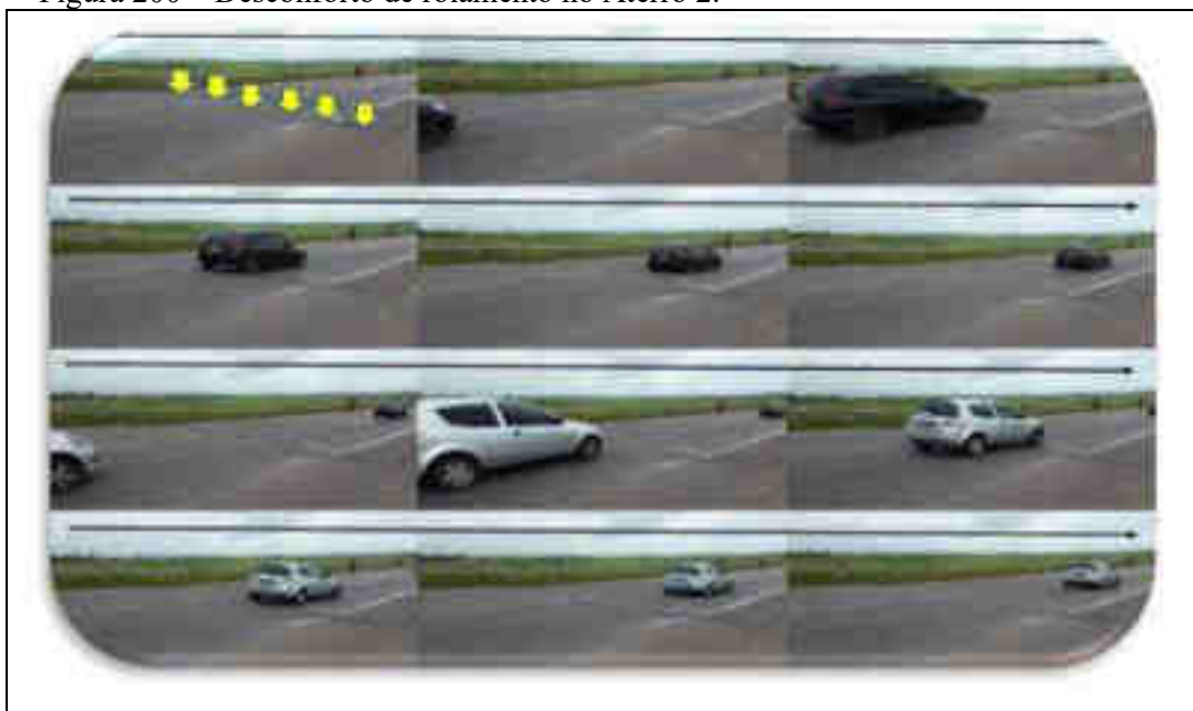
Figura 200 – Desconforto de rolamento no Aterro 2.
