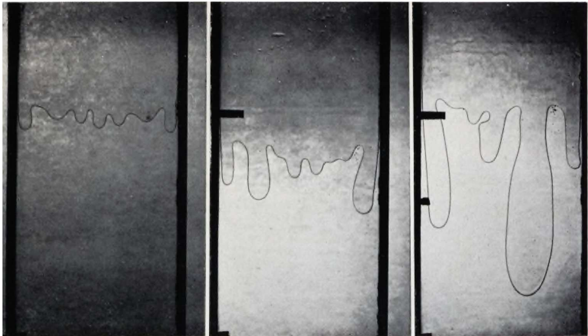
Figura 1 – Clássico experimento de Saffman e Taylor retirado da Ref. [1]. A figura mostra a interface entre dois fluidos na configuração de uma célula de Hele-Shaw retangular, sendo o fluido superior ar (baixa viscosidade), e o fluido inferior glicerina (alta viscosidade). A interface inicial é levemente perturbada, possuindo pequenas ondulações que crescem em comprimento conforme o ar penetra e desloca a glicerina. As protuberâncias que tendem a crescer neste fluxo instável são conhecidas como dedos viscosos.
