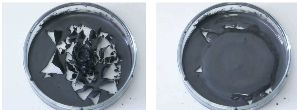
Figura 10 – Na figura à esquerda, temos um fluido magneto reológico submetido a um campo magnético perpendicular ao plano da página. Devido ao campo, as partículas do fluido tendem a se agregar e o fluido em si adquire aspecto de uma substância sólida. A partir do momento que o campo magnético é desligado, caso ilustrado pela figura à direita, o fluido rapidamente volta a escoar e se comportar como um fluido convencional.
