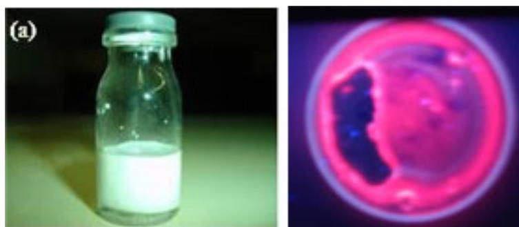
**Figura 47:** a) Fotografia dos látex P(S-HEMA) com  $[\text{Eu}(\text{btfa})_3 \cdot (\text{H}_2\text{O})_2]$  e b) látex irradiado por lâmpada ultravioleta.
