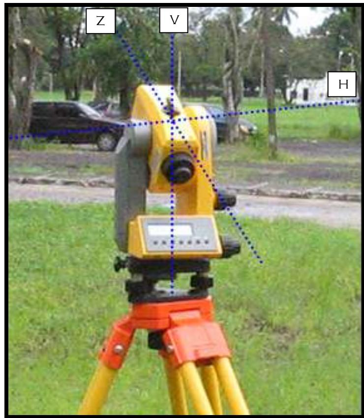
Figura 17 – Taqueômetro eletrônico utilizado
