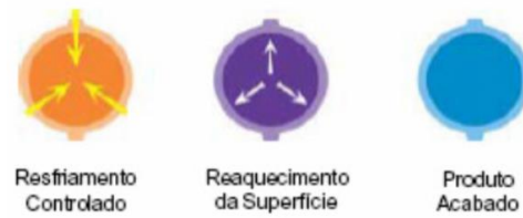
Figura 23 - Esquema de fluxo térmico na seção da barra
