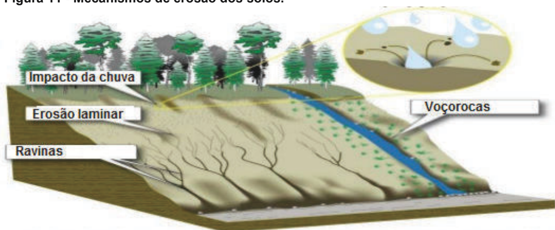
Figura 11 - Mecanismos de erosão dos solos.
