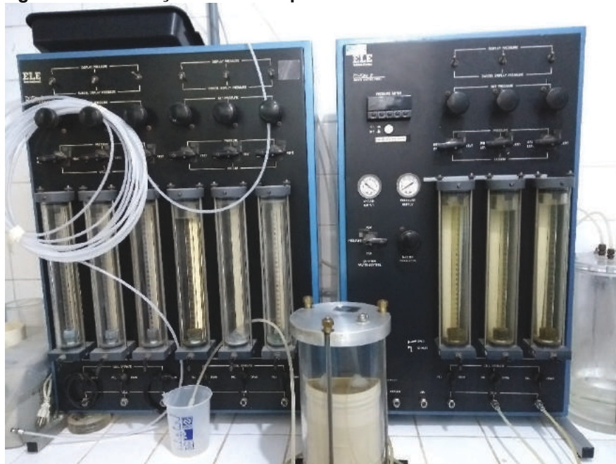
Figura 32 – Execução ensaio de permeabilidade Tri-Flex.
