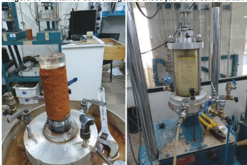
Figura 35 - Detalhes da montagem e execução do ensaio triaxial.
