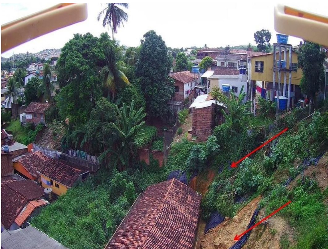
Figura 6 – Fluxo lateral de massa, registrado com o equipamento aerofotogramétrico em encostas na área urbana de Camaragibe (PE)
