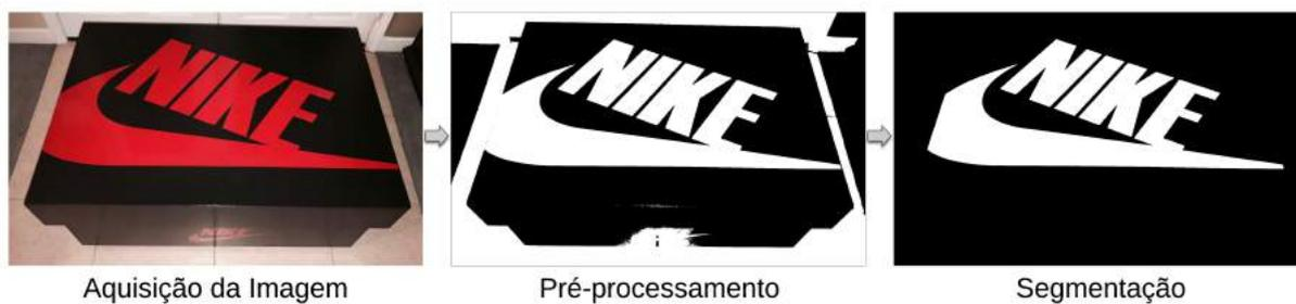
Figura 95 – Processo de segmentação/binarização da logomarca da Nike na tampa da caixa, observa-se oclusões na forma.
