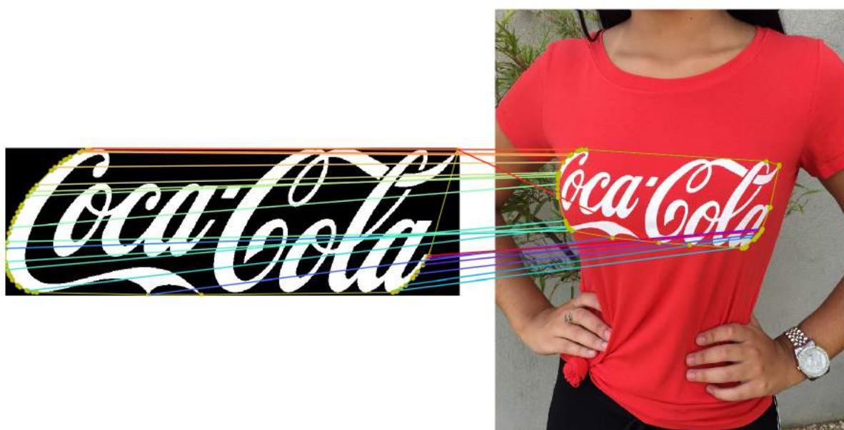
Figura 109 – Resultado da comparação: O número de associações entre os Vértices é 22, o objeto *template* contém 53 Vértices e o objeto da cena real possui 41 Vértices.
