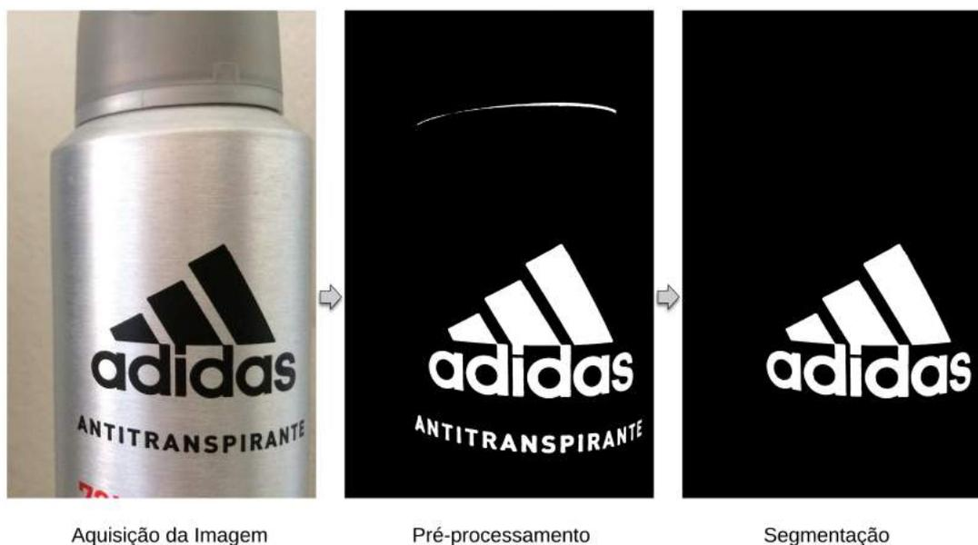
Figura 104 – Processo de segmentação da logomarca Adidas impressa no desodorante.
