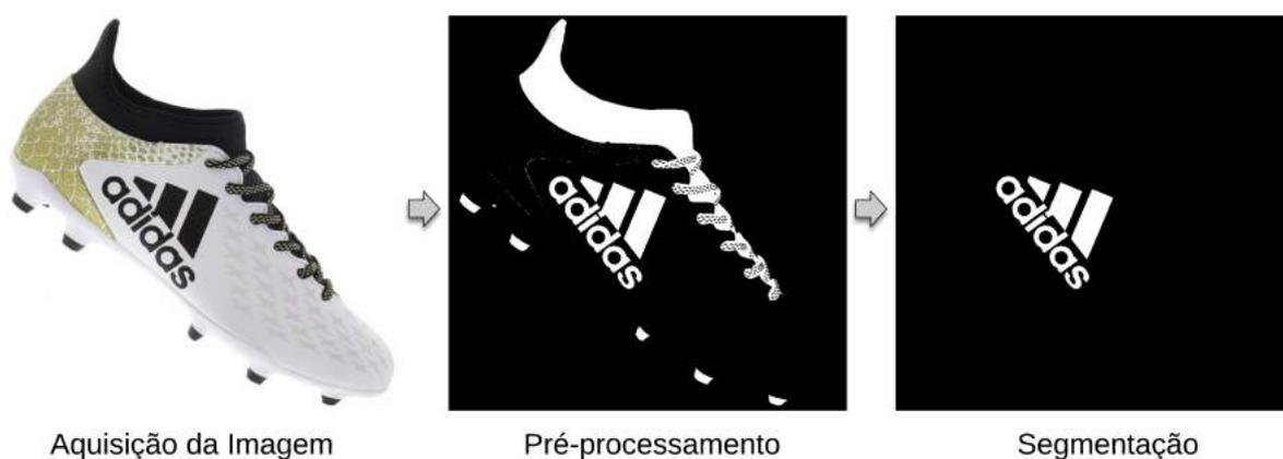
Figura 90 – Processo de segmentação da logomarca da Adidas na chuteira.
