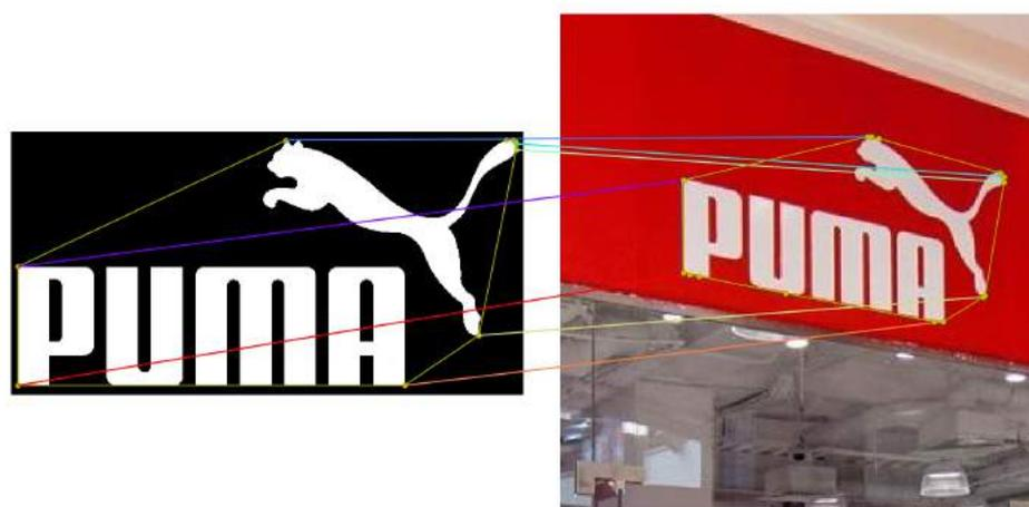
Figura 94 – Resultado da comparação: O número de associações entre os Vértices é sete, o objeto *template* contém dez vértices e o objeto *query* possui 15 vértices.
