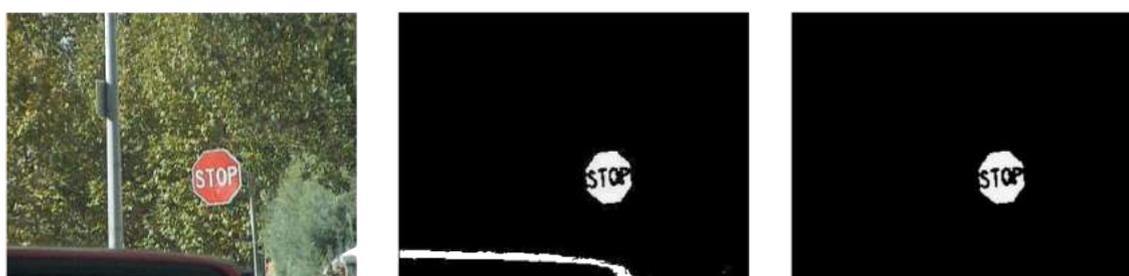
Figura 6 – Exemplo de segmentação de placa de trânsito em uma cena natural através de uma limiarização no espaço de cores HSI, retirado de (MALDONADO-BASCÓN et al., 2007).
