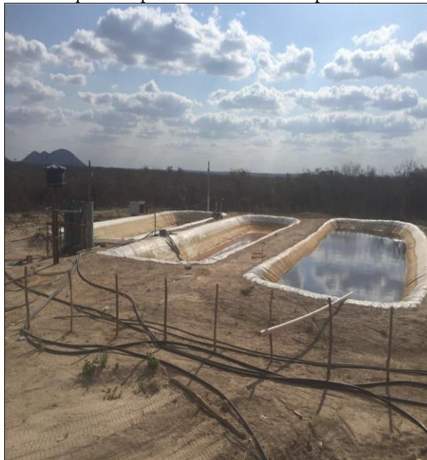
Figura 15: Tanques receptores constituintes do processo de lixiviação
