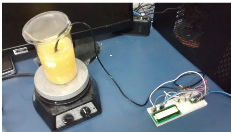
Figura 7 - Sistema para teste de transesterificação em batelada.
