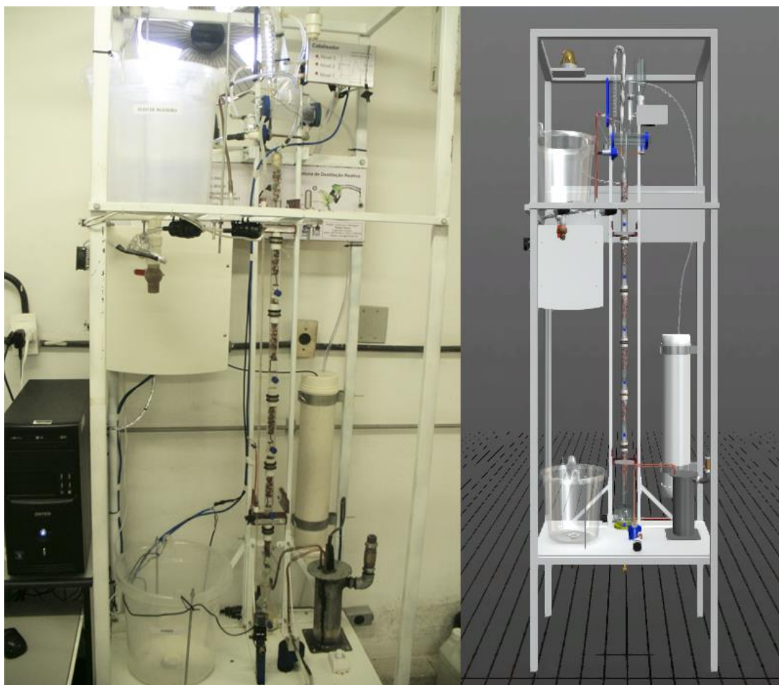
Figura 6 - Configuração final da coluna de destilação reativa, e representação 3D da coluna no supervisor.
