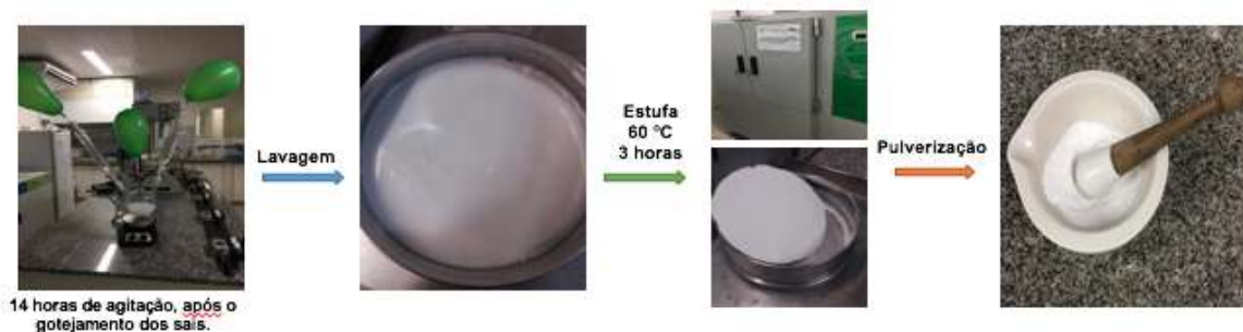
Figura 13 – Esquemática da síntese de por co-precipitação, lavagem e secagem do HDL.
