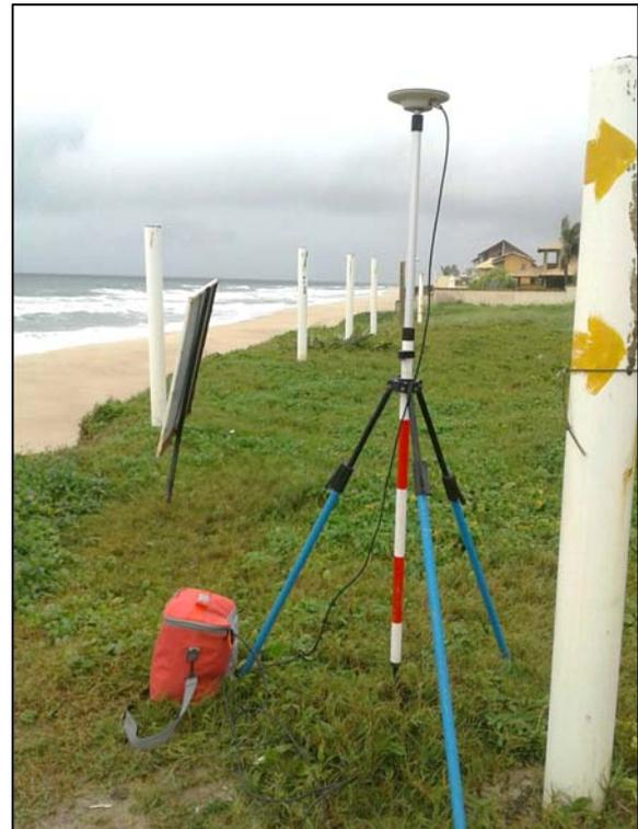
Para o processamento e pós-processamento dos dados obtidos pelo receptor GNSS, utilizou-se o software Ashtech Solutions 2.7, que ao fim dos trabalhos forneceu as coordenadas geodésicas ajustadas do conjunto de pontos definidores da linha de preamar máxima.
