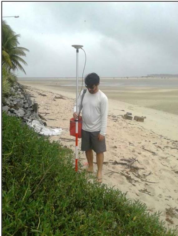
Figura 45 - Receptor Base: Utilizado como ponto de referência para o ajustamento das coordenadas.
