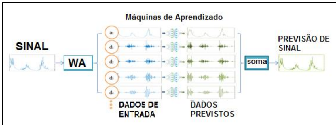
Figura 62 - Segundo modelo (modelo 3) de acoplagem das máquinas com a transformada wavelet .
