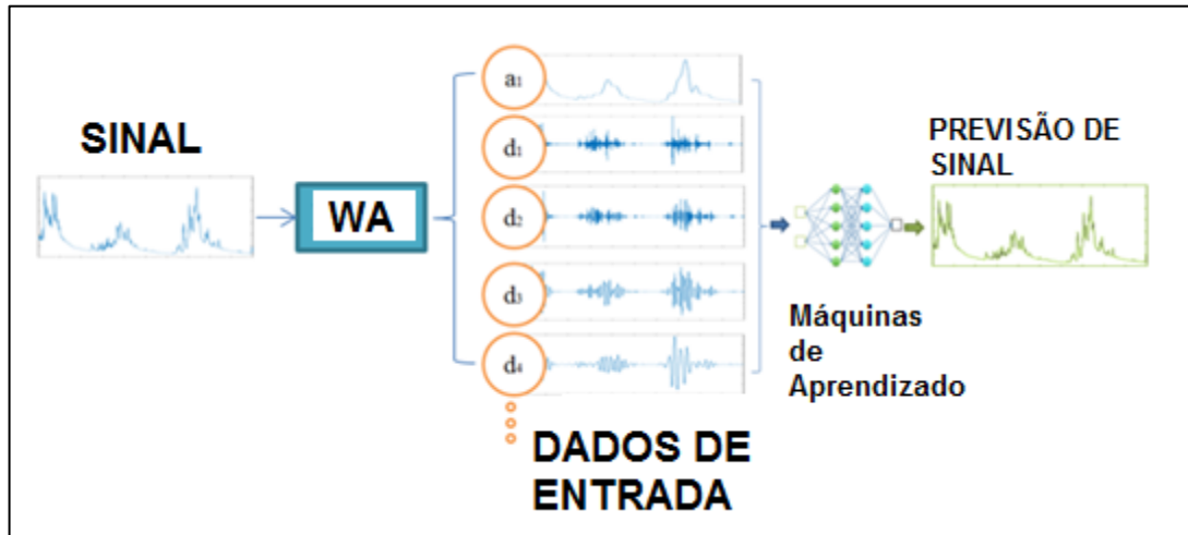
Figura 61 - Primeiro modelo (denominado de modelo 2) de acoplagem das máquinas com a transformada wavelet.
