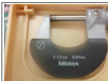
**Figura 4.8.** Micrômetro.
