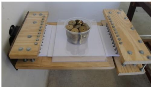
**Figura 4.14.** Esquema para obtenção do coeficiente de atrito estático experimental.
