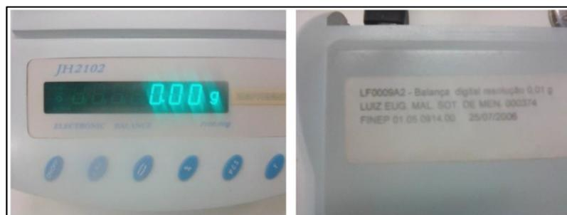
**Figura 4.7.** Balança digital.
