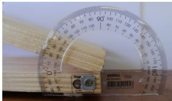
**Figura 4.19.** Transferidor instalado na base inferior do plano inclinado.
