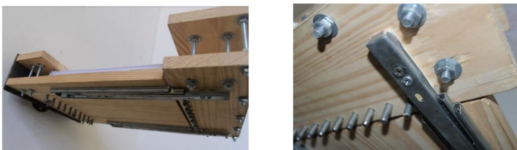
**Figura 4.3.** Vista dos trilhos telescópicos instaladas sob as bases de madeira.
