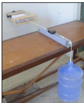
**Figura 4.12.** Esquema completo para nossa nova estratégia de medir a força para separação das folhas intercaladas.
