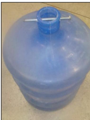
**Figura 4.10.** Garrafão de 20 litros com o parafuso atravessado no gargalo.
