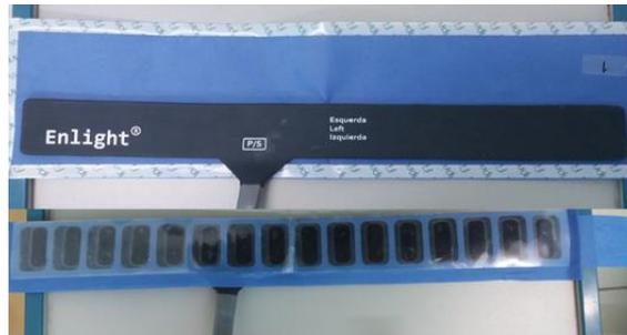
**Figura 12** Faixas descartáveis da cinta da tomografia de impedância elétrica com 16 pares de eletrodos.
