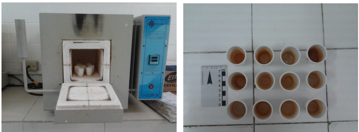
Figura 33 e 34 - cadinhos de porcelana na mufla (550°C) para a queima na matéria orgânica (extração da fase orgânica do P).
