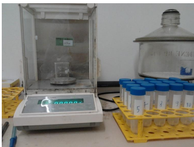
Figura 26 e 27 - balança de precisão e os tubos de centrifugação de plástico sendo pesados.
