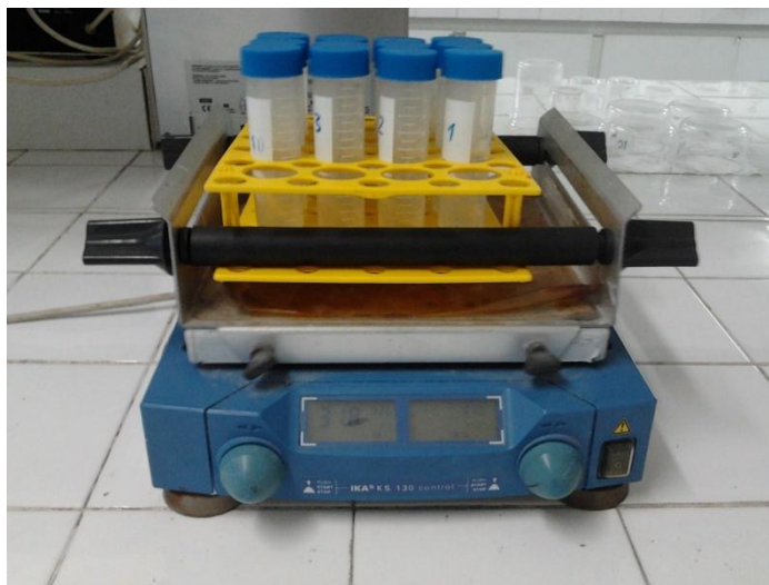
Figura 28 – tubos de centrifugação de plástico sendo agitados com a solução de HCl numa concentração de 1M na mesa giratória.
