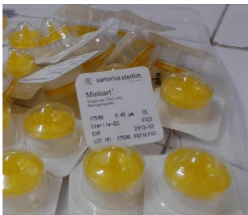
Figura 29 e 30 - filtros de 0,45µm e tubos com a solução contendo o P inorgânico filtrada após a agitação mecânica.
