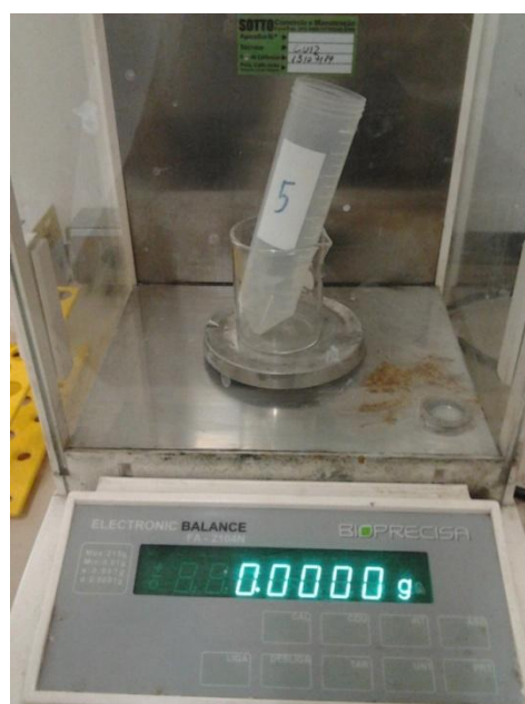
Figura 26 e 27 - balança de precisão e os tubos de centrifugação de plástico sendo pesados.
