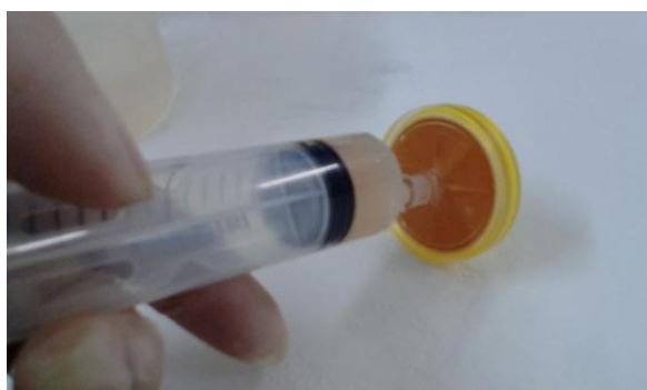
Figura 35, 36 e 37 – solução de 1M de HCl com os sedimentos sendo filtrados com a seringa e filtros de 0,45 \mu\text{m} , filtrando e extraíndo a solução com a fase orgânica do P.
