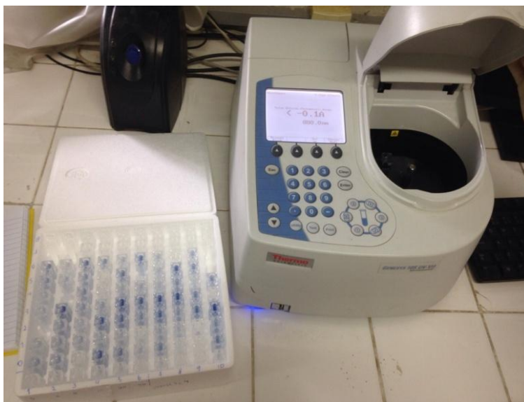
Figura 39 e 40 - cubetas de polimetilmetacrilatos preenchidas pelo Mixing e 0,4ml da solução da amostra contendo a fase de P a ser analisada pelo espectrofotômetro de absorção.
