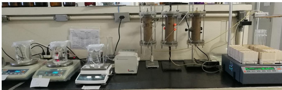
Figura 15 - Dispositivo experimental da caracterização hidrodispersiva das camadas heterogêneas
