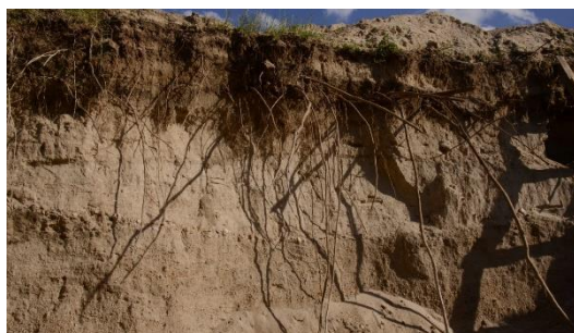
Figura 16 - Trincheira para avaliação do perfil do depósito aluvionar
