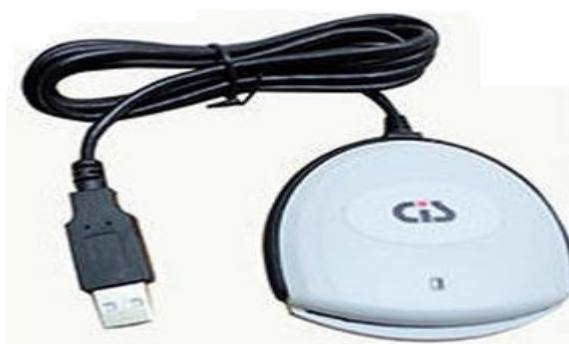
Figura 22 – LEITORA DE SMART CARD (CONEXÃO PELA PORTA USB)
