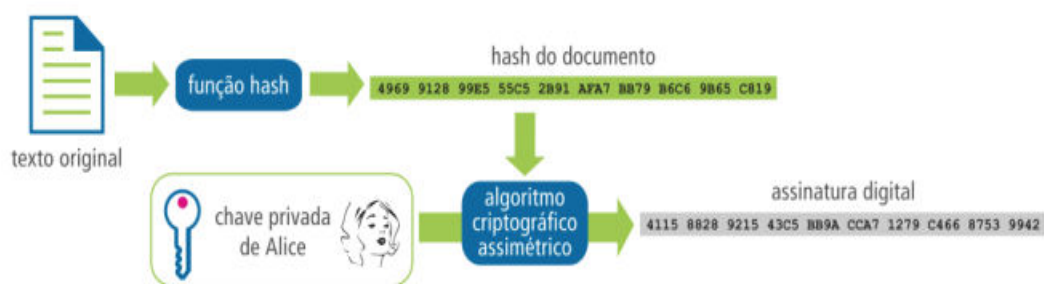
Figura 17 – FUNÇÃO HASH E ALGORITMO DE CRIPTOGRAFIA ASSIMÉTRICA
