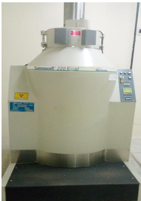
Figura 9 - Irradiador Gammacell Cobalt-60 pertencente ao Departamento de Energia Nuclear da Universidade Federal de Pernambuco.
