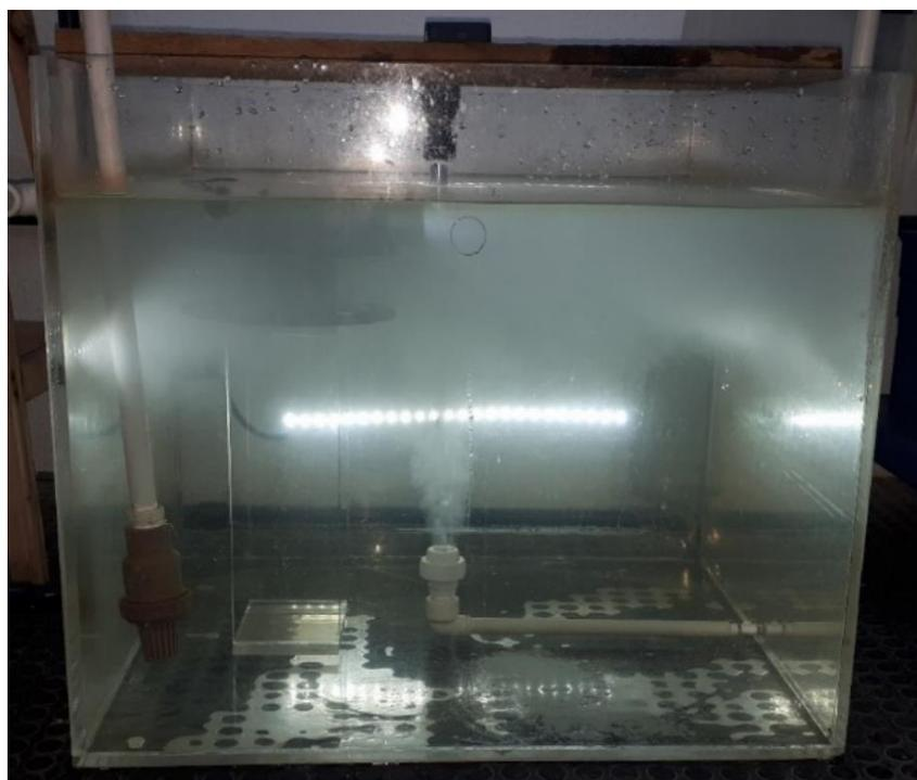
**Figura 43** – Perfil de Produção de Microbolhas do Ensaio 21 do Planejamento Biológico
