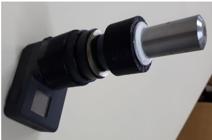
**Figura 16** – GoPro Hero 6 com Lentes de Microscópio e Peças 3D para Medição de Microbolhas
