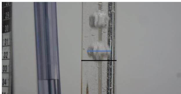
**Figura 7** - Exemplo de Medição das Bolhas no Medidor de Vazão de Ar
