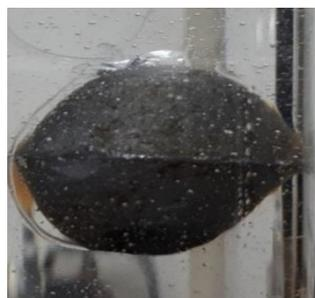
**Figura 6** - Chumbada utilizada para medição do fator de correção
