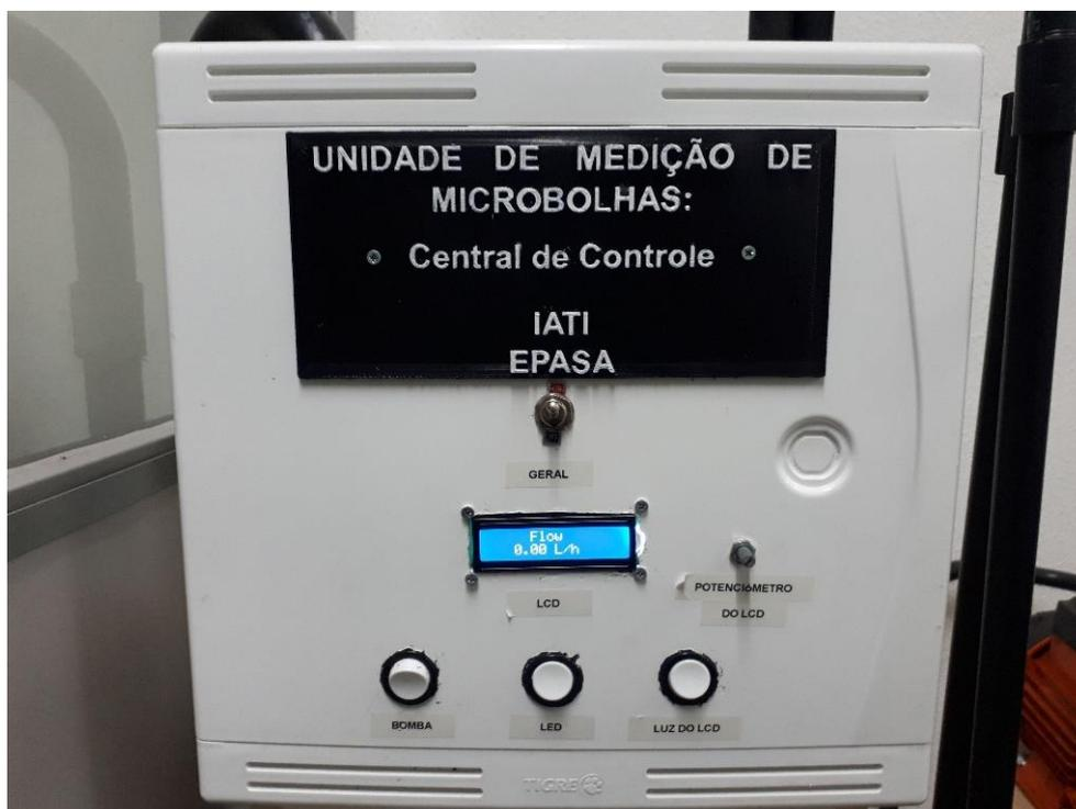
Figura 15 – Painel da Unidade de Medição de Microbolhas
