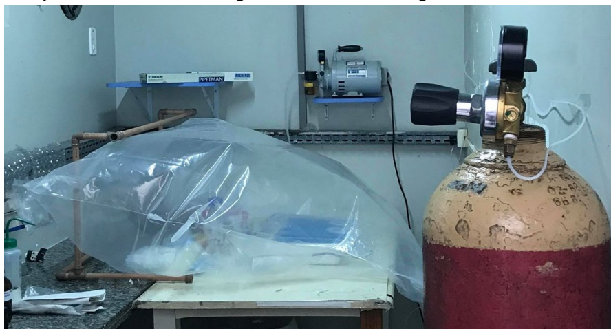
Figura 13- Foto do plástico semelhante a “glove-bag” com atmosfera preenchida de N_2/CO_2 e cilindro e bomba à vácuo que auxiliavam na troca gasosa de dentro da bag.
