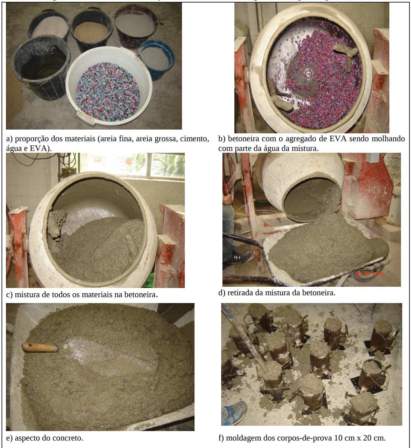
Figura 4.2 – Detalhe da execução da mistura e da moldagem dos corpos-de-prova.
