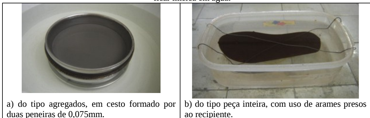
Figura 3.2 – Ensaios de absorção de água nas amostras de EVA, com artifícios que forcem a amostra ficar imersa em água.
