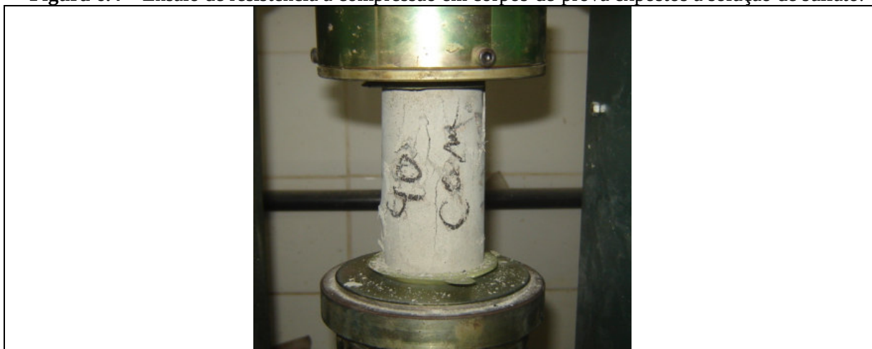
Figura 6.4 – Ensaio de resistência à compressão em corpos-de-prova expostos à solução de sulfato.
