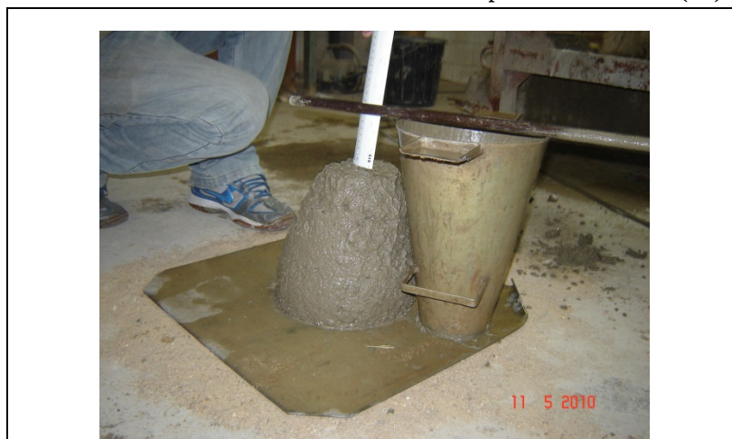
Figura 4.9 – Ensaio de abatimento do tronco de cone para a mistura 40/(60)-EVA40.
