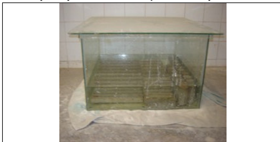
Figura 6.2 – Corpos-de-prova imersos em solução de sulfato, apoiados em filetes de vidro.
