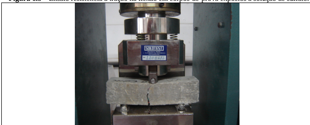
Figura 6.5 – Ensaio resistência à tração na flexão em corpos-de-prova expostos à solução de sulfato.
