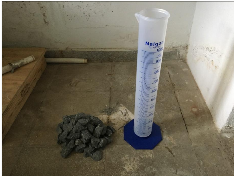
Figura 11 – Ensaio de porosidade para brita de tamanho desconhecido
