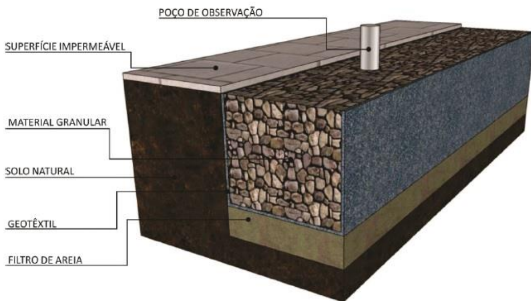
Figura 2 – Trincheira de Infiltração piloto no sitio experimental do grupo de física do solo da UFPE
