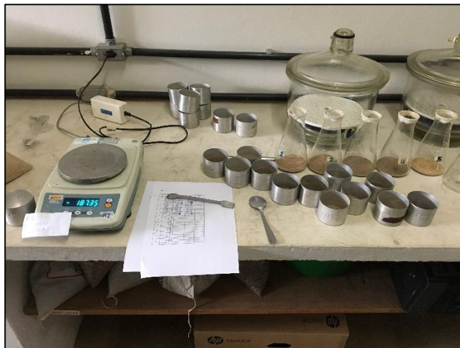
Figura 15 – Adição de 70 gramas de solo ao erlenmeyer
