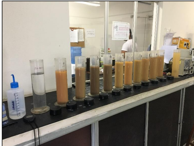
Figura 16 – Processo de leitura de densidade e temperatura do solo, referente à sedimentação
