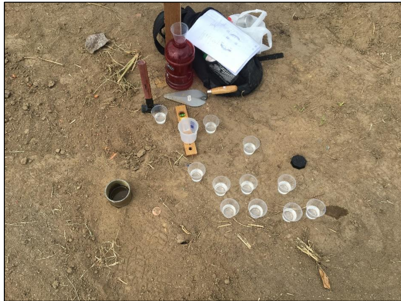
Figura 19 – Realização do ensaio de infiltração de campo
