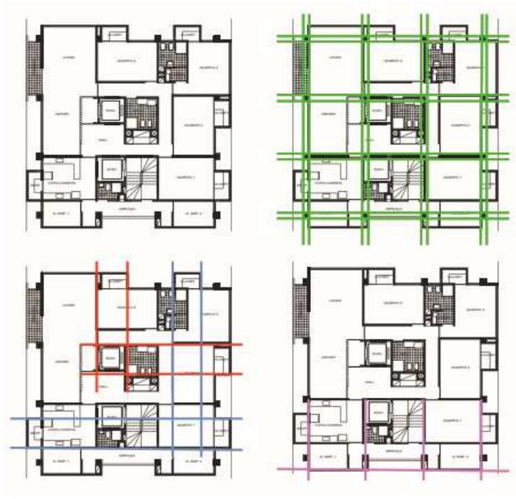
Figura 10 - Traçados reguladores de segunda ordem: a. Planta baixa; b. Componentes lineares; c. Eixos ordenadores das superfícies azulejadas e em tijolo aparente; d. Eixos ordenadores das superfícies em tijolo aparente (Fonte: AMORIM, 2014, p. 16)
