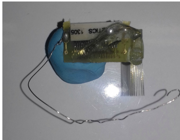
Figura 13 – Matriz de Eletrodo confeccionado no LNSC usando fios de tungstênio.
