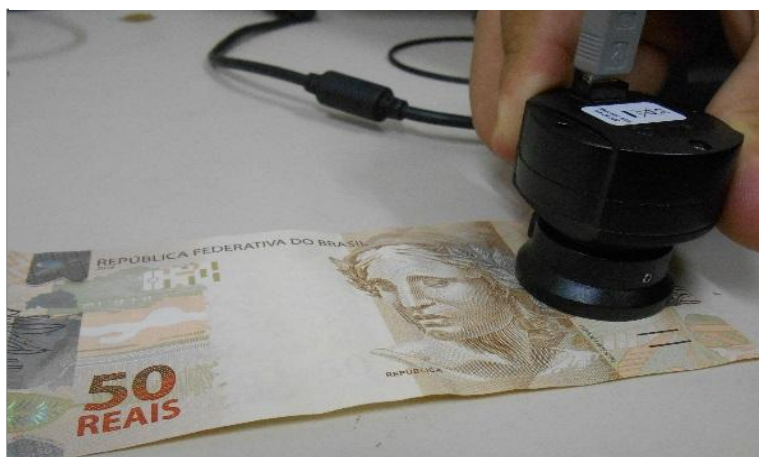
Figura 5 – Procedimento de aquisição espectral com o NIR portátil.
