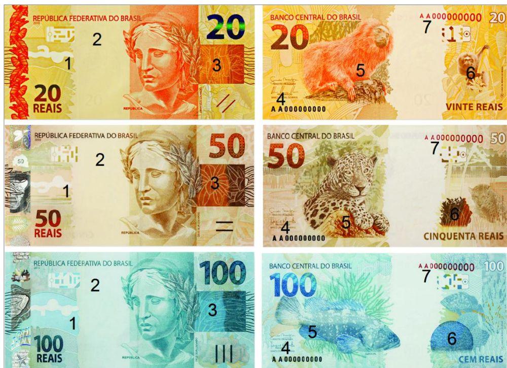
Figura 4 – Áreas analisadas nas cédulas: 1,7- fluorescentes; 2- marca d'água; 3,5,6- calcográficas, 4- tipográfica.
