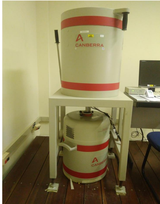
Figura 22 - Sistema EGAR com detector HPGe utilizado para a determinação de radionuclídeos naturais
