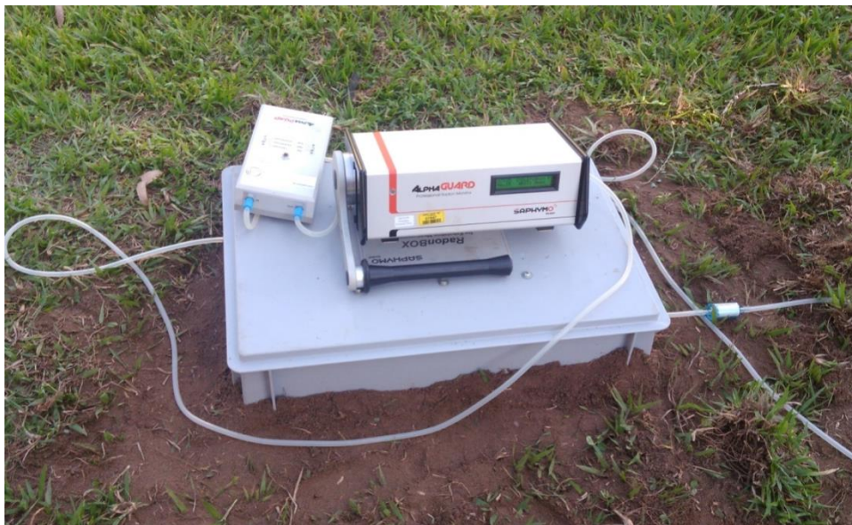
Figura 21 - Sistema de detecção utilizando a câmara RadonBOX para a determinação da taxa de exalação superficial de Rn-222 em campo
