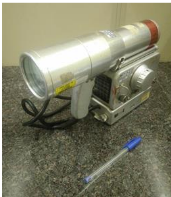
Figura 10 - Cintilômetro SAPHYMO modelo SRAT-SPP/2 para o levantamento radiométrico da área de estudo
