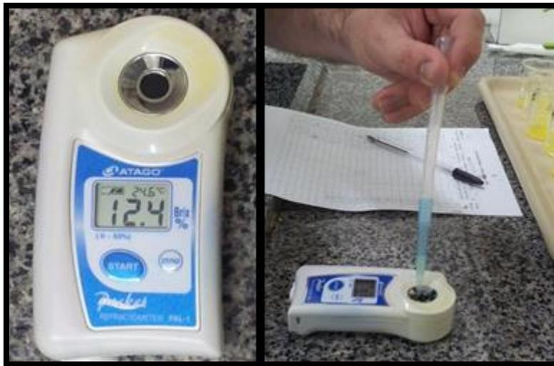
**Figura 15** – Determinação de SS empregando-se um refratômetro digital (Atago, Tóquio, Japão).
