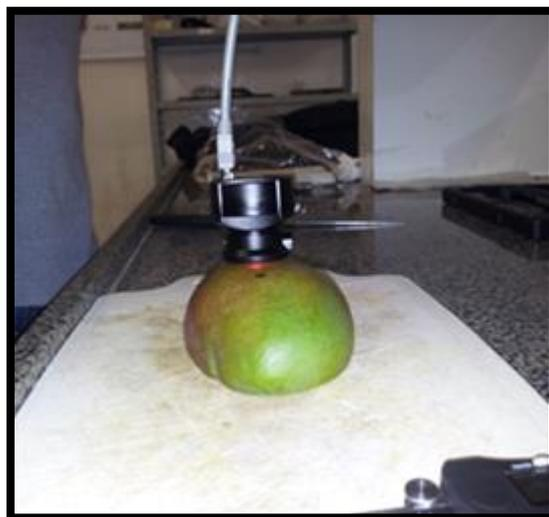
**Figura 12** – Aquisição de espectros de uma fatia inteira de manga (~ 31 mm). As medidas foram realizadas posicionando-se o espectrômetro diretamente sobre a casca de uma da fatia e um suporte de polietileno do lado oposto
