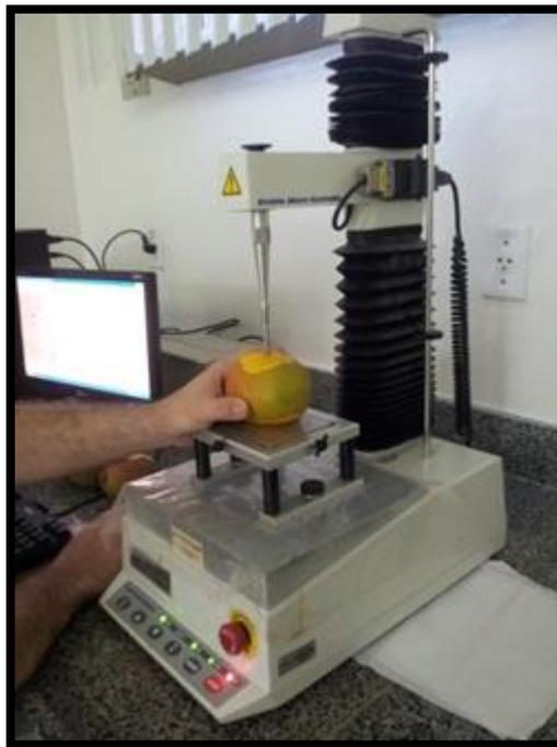
**Figura 17** – Determinação de FP empregando-se um texturômetro digital (modelo TA.XT Plus, Extralab, Jarinu, SP, Brasil).
