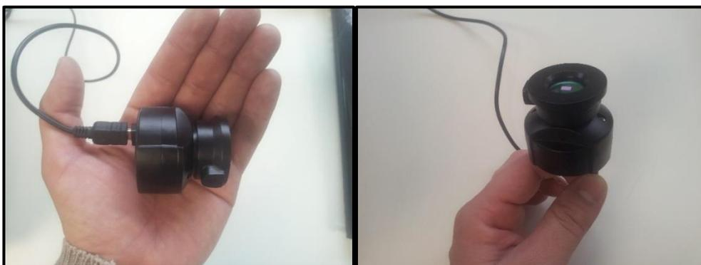
**Figura 2** – Espectrômetro NIR portátil modelo MicroNIR 1700 (VIAVI, CA, EUA): exemplo de equipamento portátil dispersivo, que emprega um filtro linear variável (LVF) associado a um arranjo de fotodiodos para efetuar a decomposição do feixe luminoso e viabilizar a seleção dos comprimentos de onda específicos.
