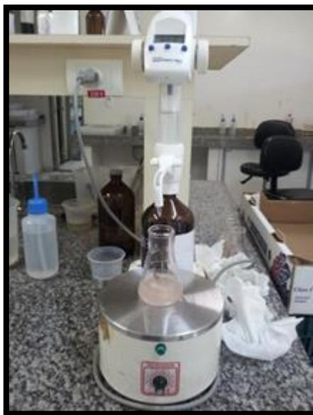
**Figura 16** – Determinação de AT empregando-se uma bureta digital (modelo Digitrator Pro, Jencons, Franklin, KY, EUA).
