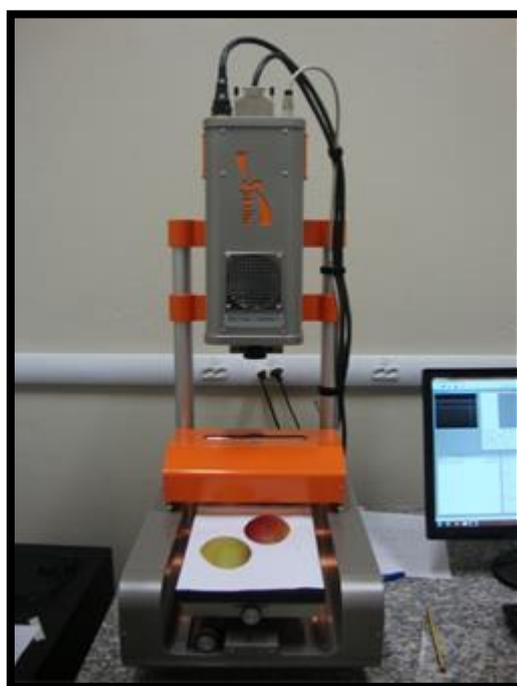
**Figura 18** – Sistema de aquisição de imagens SisuCHEMA SWIR (Specim Spectral Imaging Ltd., Oulu, Finlândia).
