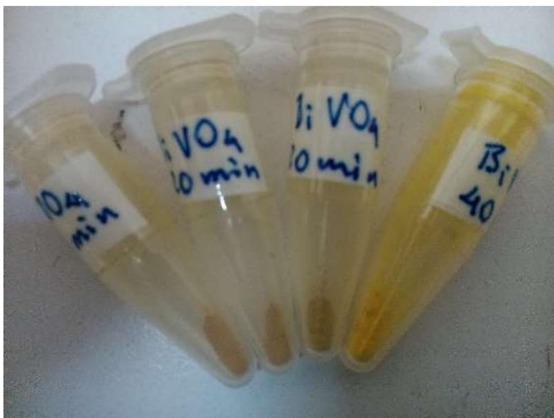
Figura 56 - Coloração das amostras de  $\text{BiVO}_4$  com o tempo de ablação. Da esquerda para a direita 10, 20, 30 e 40 minutos
