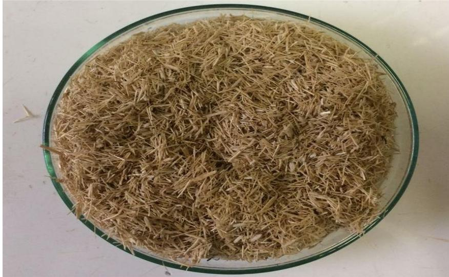
**Figura 20** - Material lignocelulósico após extração ácida e processo de secagem
