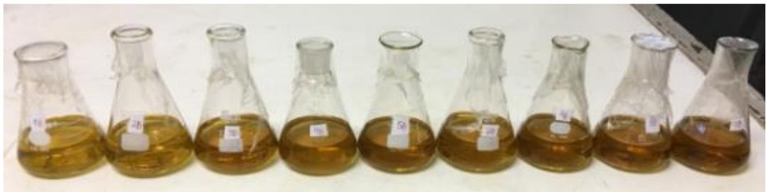
**Figura 21** - Solução oriunda do processo de filtração a vácuo da extração básica
