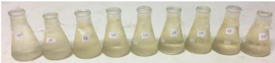
**Figura 18** - Solução oriunda do processo de filtração a vácuo, da extração ácida
