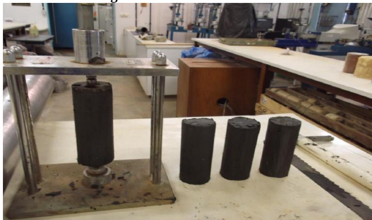
(a) Moldagem dos corpos de prova em torno de moldagem
