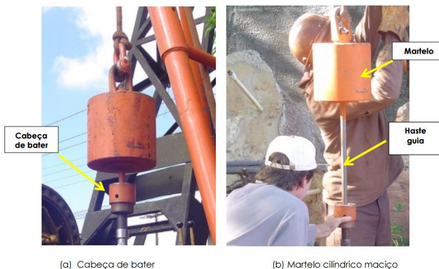
Figura 3 – Equipamento de sondagem SPT.
