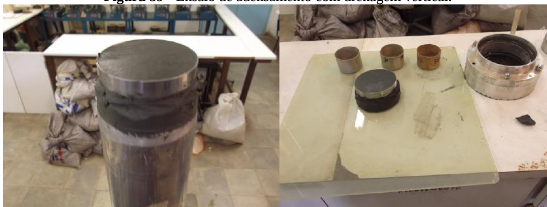
(a) Moldagem dos corpos de prova em anéis de aço
