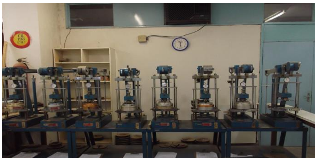
(b) Ensaios de adensamentos com drenagem vertical em execução nas prensas oedométricas.
