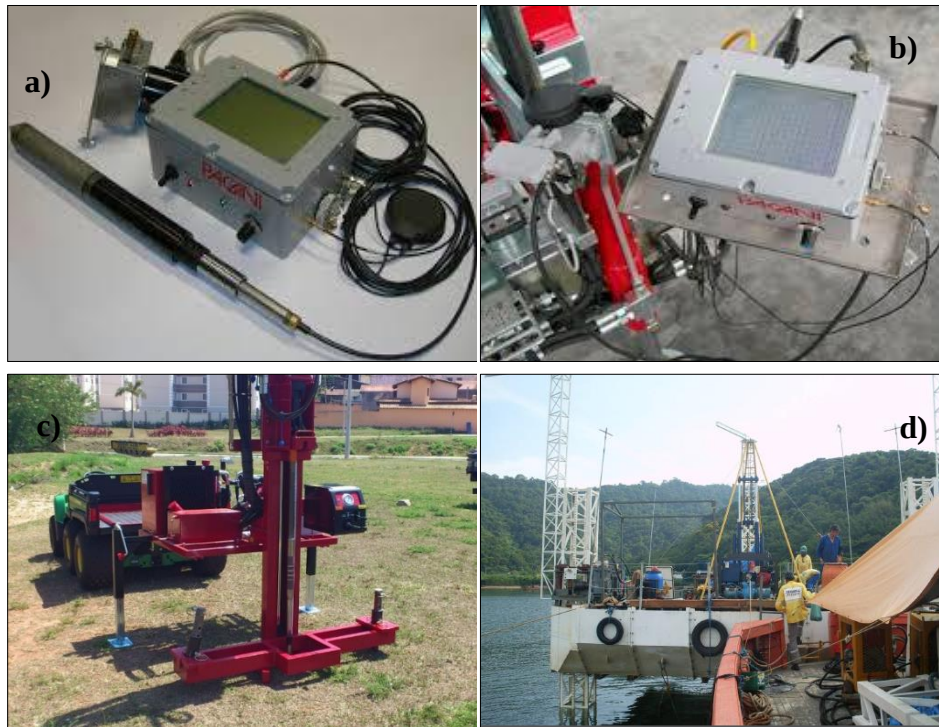
Figura 6 - Componentes do equipamento do ensaio de piezocone.
