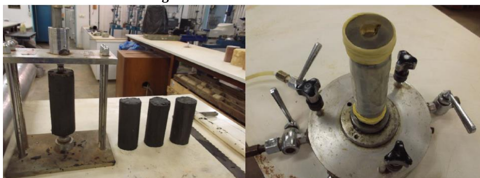
(a) Moldagem dos corpos de prova no torno
