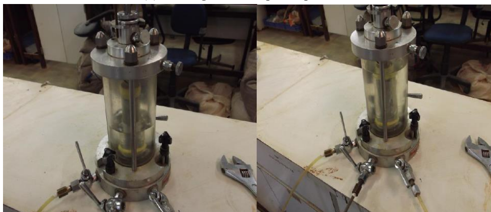
(b) Montagem dos corpos de prova em células triaxiais
