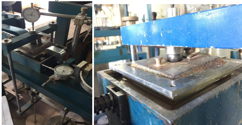
Figura 25 - Ensaio de cisalhamento direto em andamento
