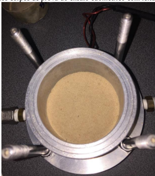
Figura 29 - Preparação dos corpos de prova do ensaio edométrico com leitura das tensões horizontais
