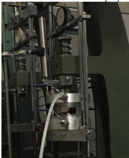
Figura 30 - Célula Edométrica utilizada na pesquisa.
