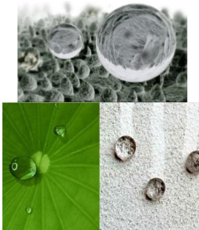
**Figura 49.** Detalhe e analogia entre a água numa folha de lótus e a tinta Lotusan aplicada na parede.
