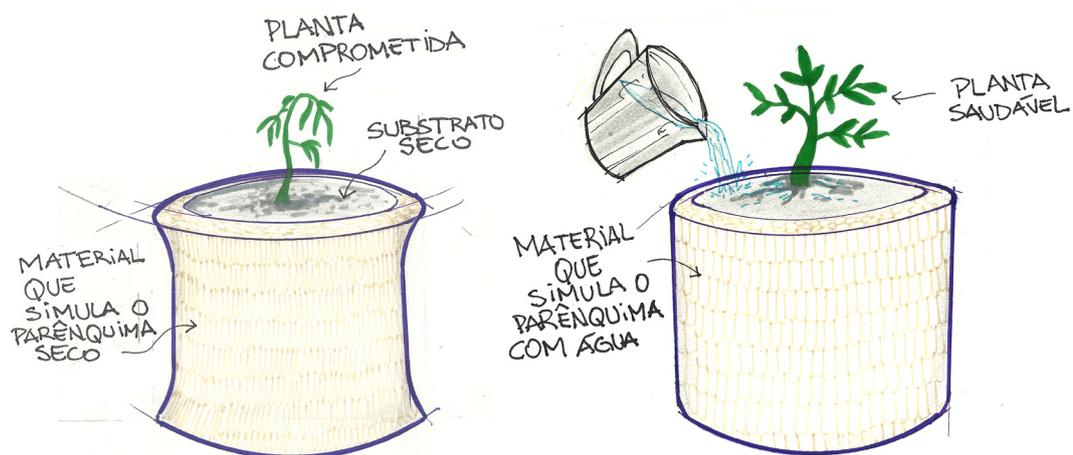
**Figura 95.** Desenho esquemático da interpretação da água feita pelo material especial por entre as paredes externas
