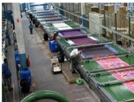
Figura 45: Vista de máquina de estampar à quadro industrial.
