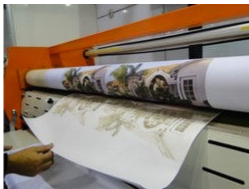
Figura 48: Impressão por sublimação, transferindo desenhos do papel para o tecido.
