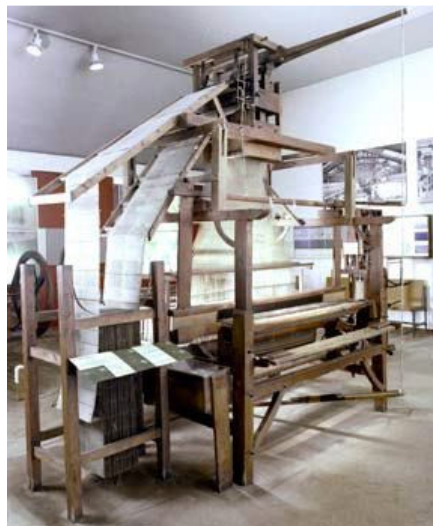
Figura 9: Cartões perfurados do tear Jacquard em imagem ampliada.
