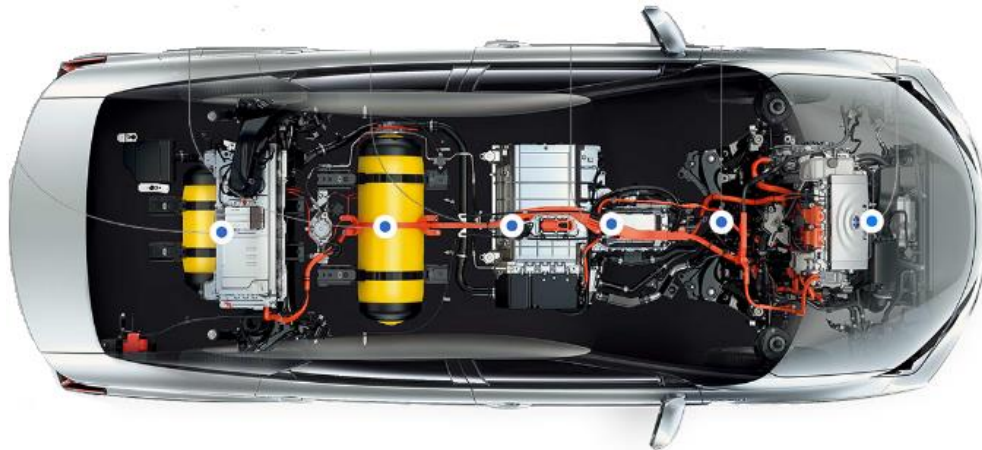
Figura 3. Componentes do sistema do Toyota Mirai, com destaque em amarelo para os tanques de fibra de carbono usados no armazenamento de hidrogênio. Adaptado da ref.[61].
