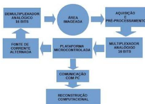
Figura 2. diagrama de blocos do protótipo.
