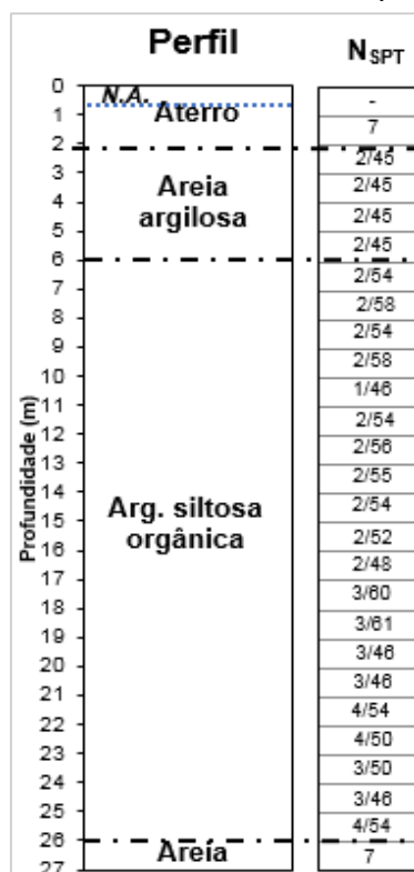
Figura 92 - Exemplo de sondagem da unidade geológica Qpm: (Clube Internacional/Madalena)
