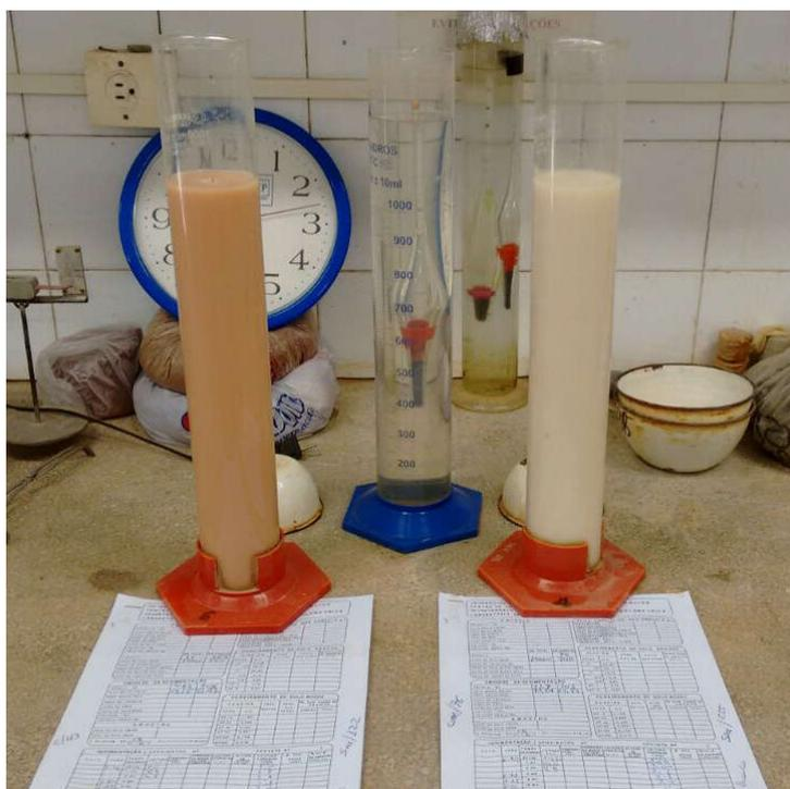
Figura 29 - Ensaio de sedimentação.
