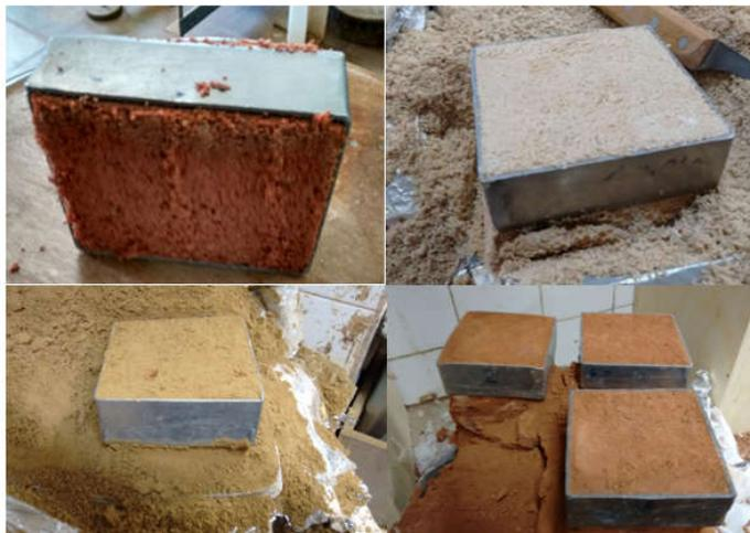
Figura 42 - Moldagem dos Corpos de Prova Para Ensaio de Cisalhamento Direto.
