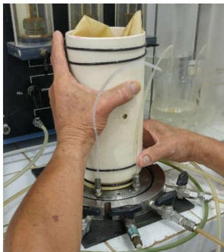
Figura 38 - Fixação da Membrana com Ligas de Borracha.
