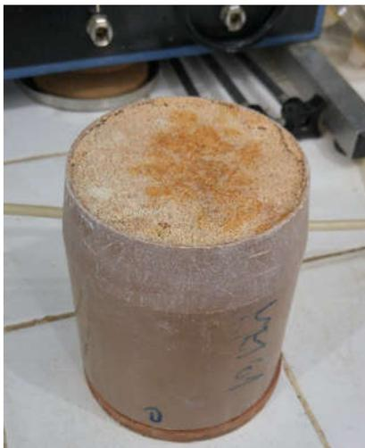
Figura 35 - Corpo de Prova Moldado.
