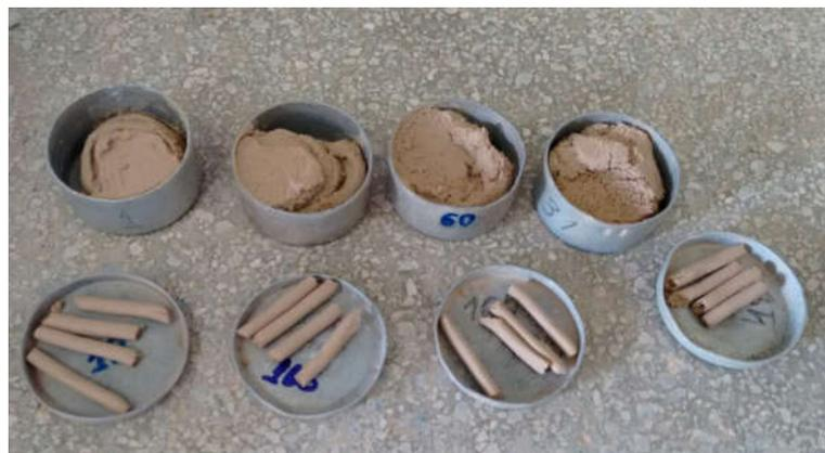
Figura 30 - Determinação de limites de consistência.
