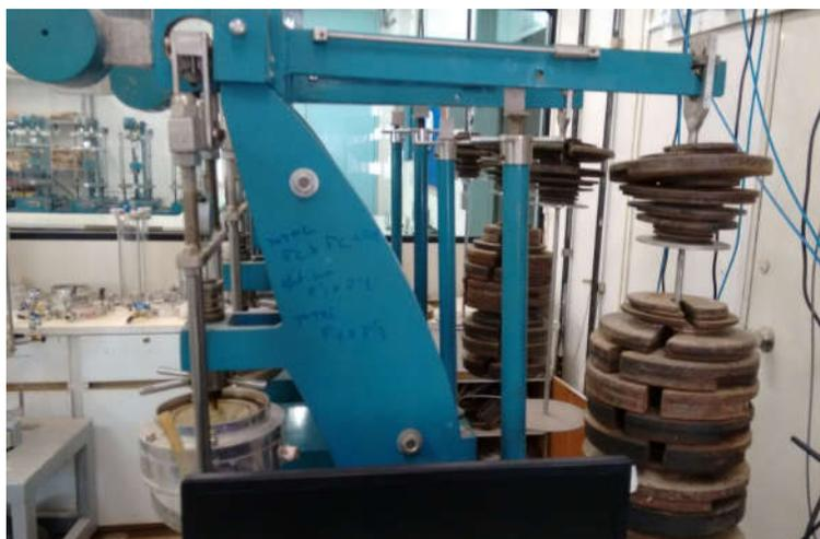
Figura 33 - Prensa edométrica carregada.
