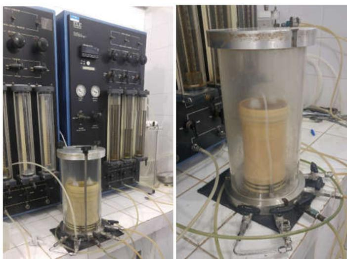
Figura 40 - Célula de Ensaio Finalizada.
