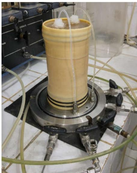
Figura 39 - Conexão das Mangueiras de Drenagem ao "Top Cap".
