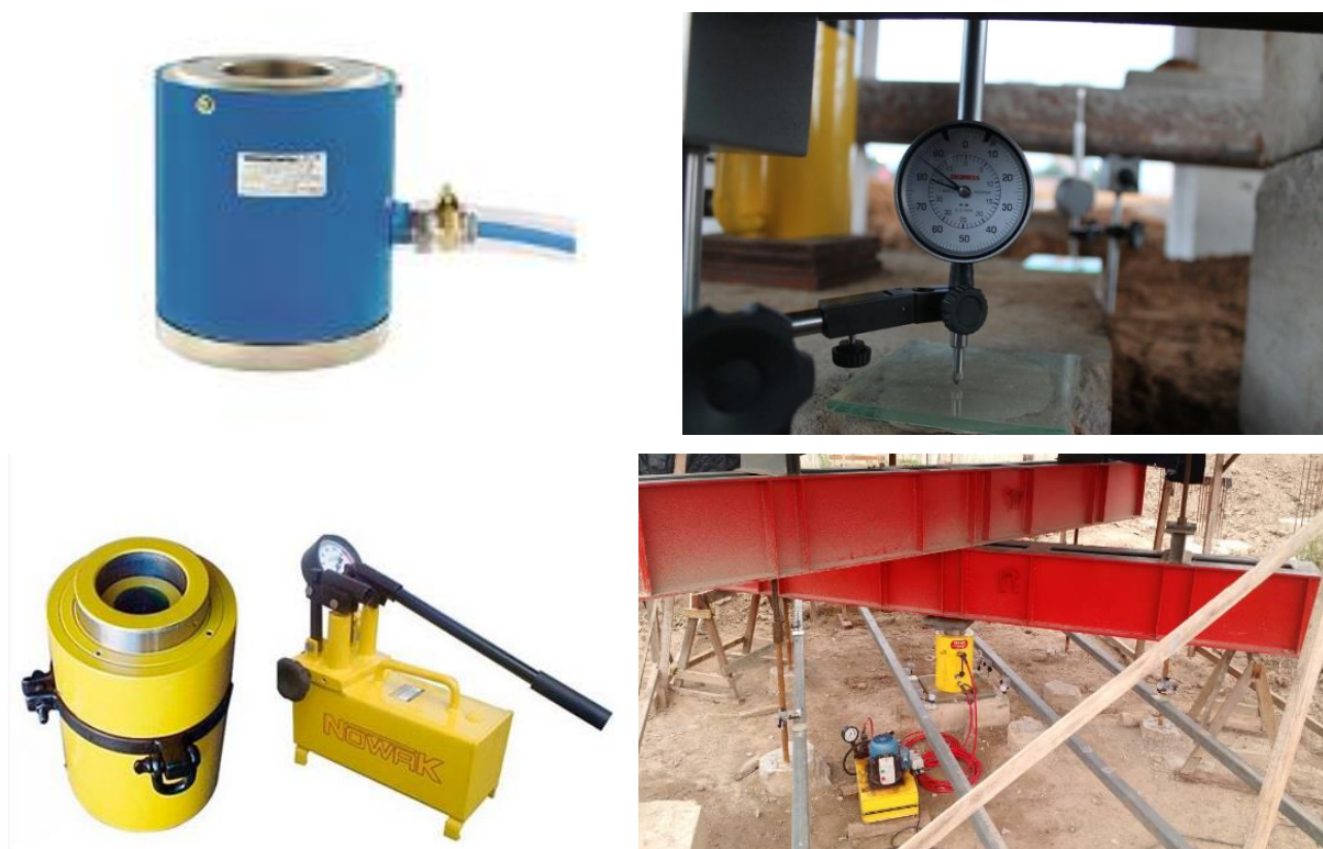
Célula de carga (esquerda superior); Relógio comparador (direita superior); Conjunto bomba e macaco hidráulico (esquerda inferior); Conjunto de vigas (direita superior).
