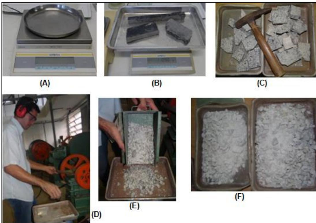
Figura 9: A) Balança de precisão; B) Pesagem dos rejeitos graúdos; C) Cominuição manual com o uso do martelo; D) Britagem; E) Coleta do rejeito britado; F) Detalhe do rejeito britado.
