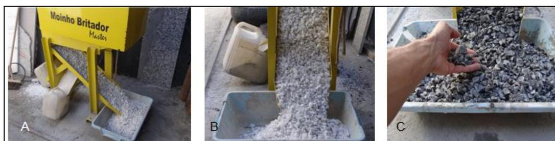
Figura 19: A) Britador; B) Brita do mármore Branco Rajado; C) Brita do granito Cinza Ocre.
