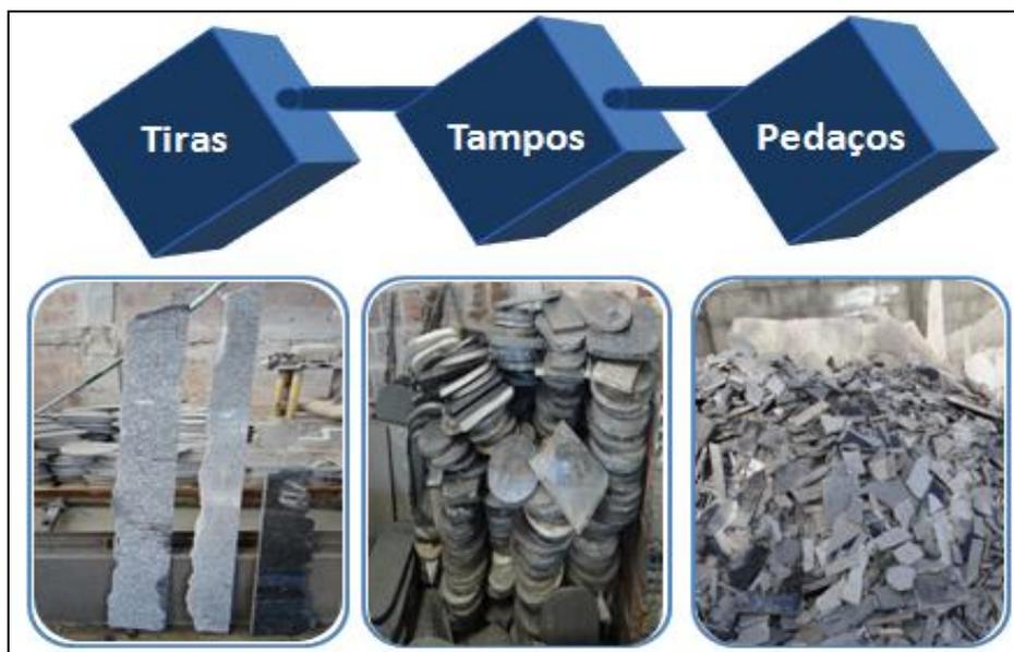
Figura 36: Tipos de rejeitos gerados no processo de produção no momento do corte
